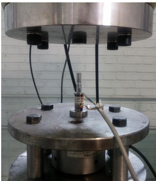
شکل ۳-۱۲: تجهیز آزمون فشردن تک‌محوری با قابلیت اندازه‌گیری کرنش محیطی.
