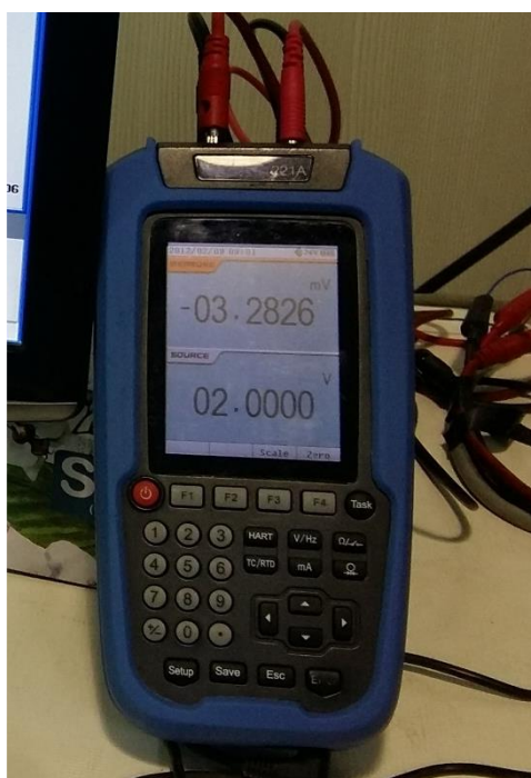
شکل ۳-۱۱: کالیبراتور مورد استفاده برای خوانش تغییرات ولتاژ کرنش‌سنج.
