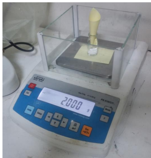
شکل ۳-۸: ترازوی با دقت اندازه‌گیری 0.001 g.
