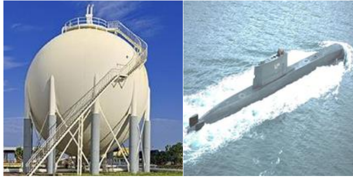
الف- پوسته‌ی استوانه‌ای در زیردریایی‌ها ب- پوسته‌ی کره‌ی مخازن تحت فشار
