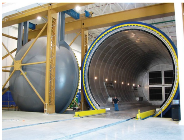
شکل ۱-۵: دستگاه اتوکلاوی که برای ساخت بال‌های هواپیمای بوئینگ ۷۸۷ استفاده شد [۵].
