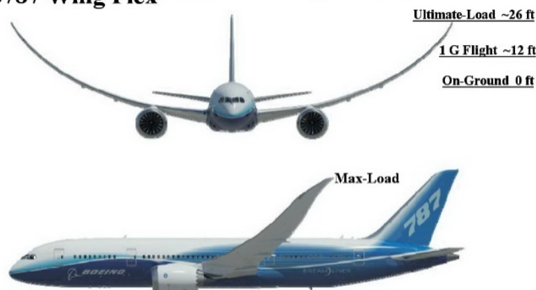
شکل ۱-۳: انعطاف‌پذیری بال‌های کامپوزیتی هواپیمای بوئینگ ۷۸۷
