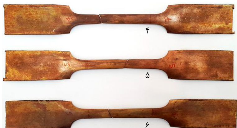
شکل ۳-۴: نمونه‌های بازپخت‌شده شکسته‌شده تحت آزمون کشش
