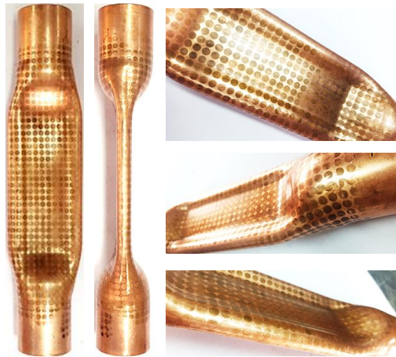
شکل ۴-۲۸: نمونه‌ی بازپخت‌شده‌ی تولیدشده به روش هیدروفرمینگ سنتی در فشار ۱۲ MPa
