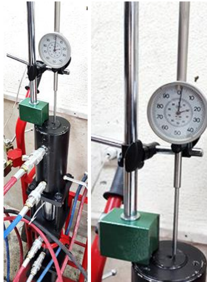
شکل ۳-۲۵: نحوه قرارگیری ساعت اندازه گیری بر روی همگام کننده
