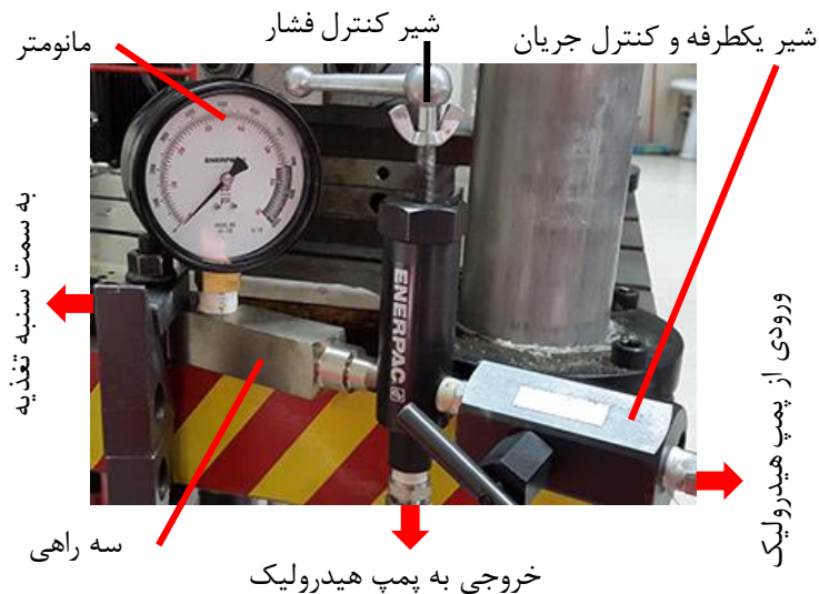
شکل ۳-۲۴: مجموعه تجهیزات کنترل فشار سیال
