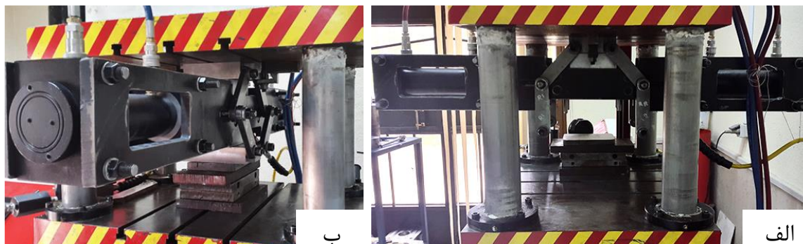
شکل ۳-۲۹: الف) نیمه بالایی قالب و صفحات قاب بسته شده به صفحه بالای پرس ب) قالب آماده شده جهت انجام فرآیند
