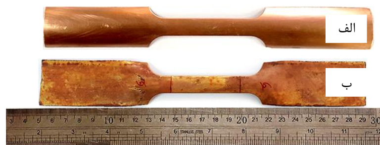
شکل ۳-۳: نمونه‌های آماده‌شده برای آزمون کشش (الف) نمونه دریافتی (ب) نمونه بازپخت‌شده
