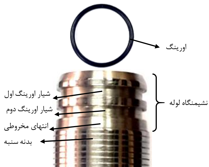
شکل ۳-۱۸: بخش‌های مختلف سر سنجه
