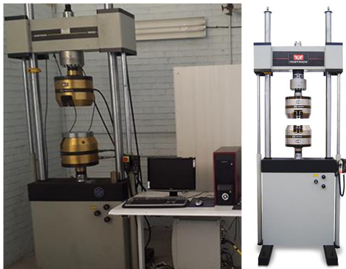
شکل ۳-۴: دستگاه آزمون کشش اینسترون ۸۸۰۲
