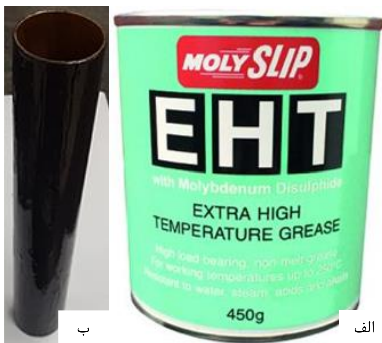
شکل ۳-۲۸: (الف) روانکار مولی‌اسلیپ (ب) نمونه آغشته به روانکار
