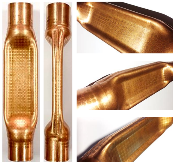
شکل ۴-۲۹: نمونه‌ی بازپخت‌شده‌ی تولیدشده به روش هیدروفرمینگ پیشنهادی در فشار ۱۲ MPa در شکل ۴-۳۰ و شکل ۴-۳۱ ارتفاع h نمونه‌های دریافتی و بازپخت‌شده مورد مقایسه قرار گرفته‌است.
