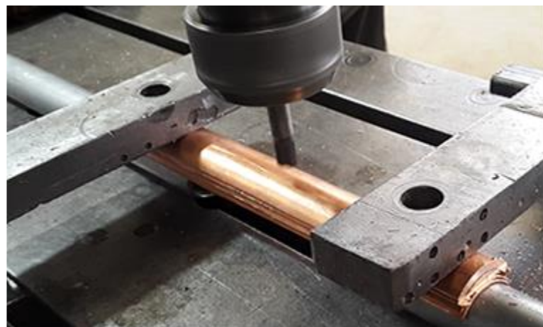
شکل ۲-۳: نحوه گیره‌بندی نمونه
