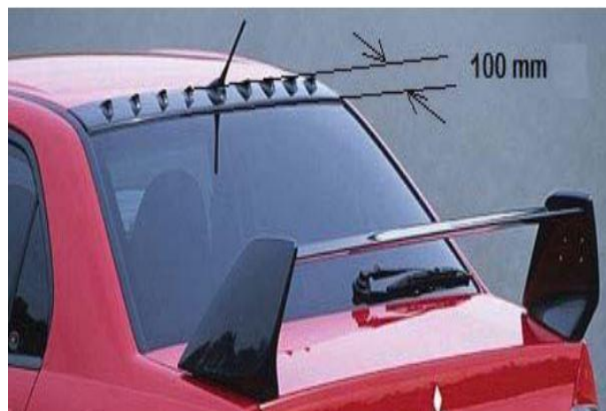
شکل ۱۰-۱: کنترل جریان روی بدنه ماشین با استفاده از ژنراتور گردابه‌ساز [۷]
