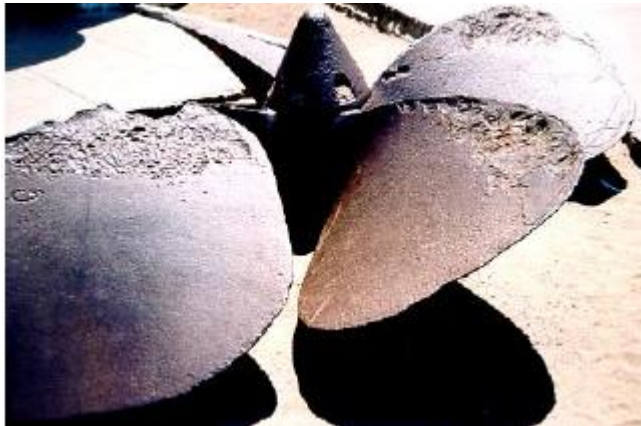
شکل ۱-۱: تخریب پروانه کشتی به وسیله پدیده کاواکزایی [۲]
