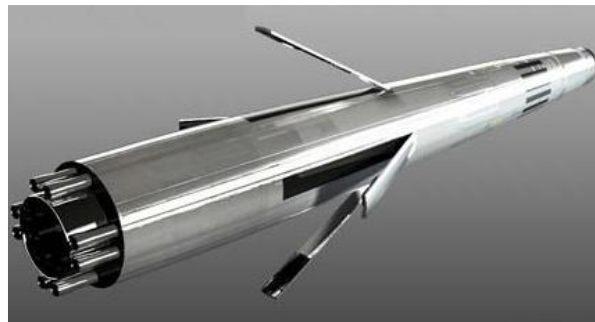
شکل ۱-۱۳: پرتابه با تکنولوژی ابرکاواک و دارای کاواکزای دیسکی
