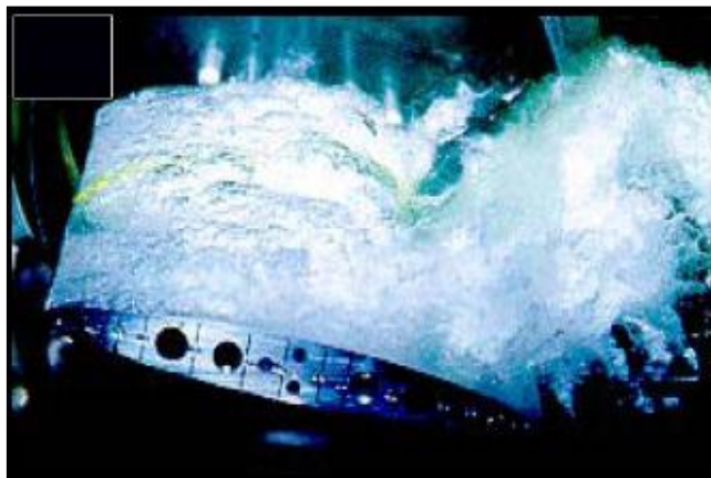
شکل ۸-۱: نمونه‌ای از یک کاواک ابری بر روی یک هیدروفویل [۴]
