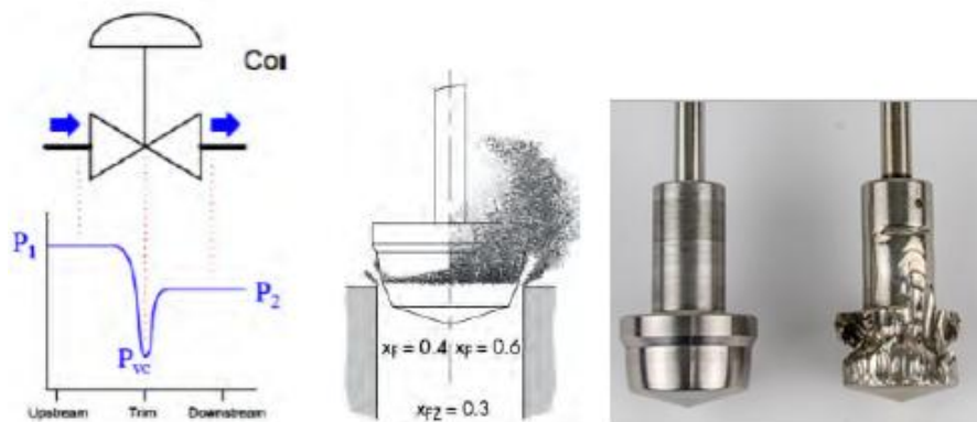
شکل ۱-۲۷: خرابی اجزاء شیر کنترل در اثر کاواک‌زایی (راست) تشکیل منطقه کاواک‌زایی (وسط) منحنی تغییرات فشار سیال در یک شیر کنترل (چپ) [۱۶]
