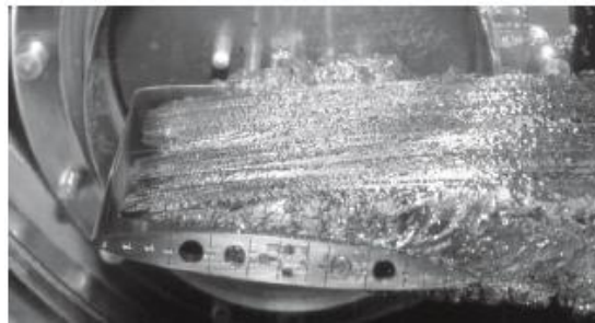
شکل ۱-۱۷: جریان ابرکاواک اطراف یک هیدروفویل در عدد کاواک‌زایی کوچک [۱۱]
