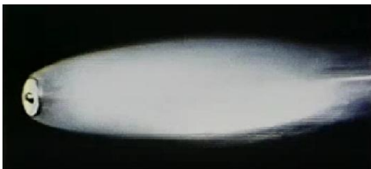
شکل ۴-۲۶: تست تجربی ابرکاواک پشت کاواک‌زای دیسکی [۵۱]
