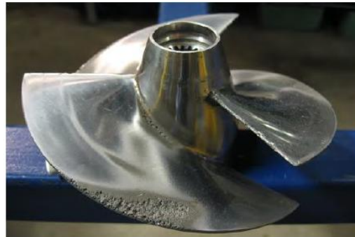
شکل ۱-۲۶: صدمات ناشی از کاواکزایی روی پروانه پمپ [۱۵]
