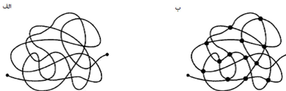
شکل (1-13): بیان شماتیک تئوری مولکول‌ها با زنجیره بلند: الف) مولکول‌های لاستیک طبیعی ب) اتصال عرضی تقویت شده مولکول‌های لاستیک طبیعی [12]
