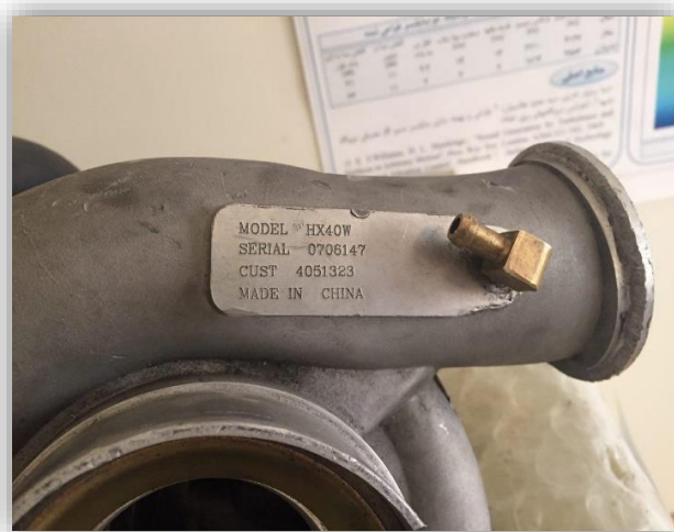
شکل ۲-۱۲ مدل و مشخصات توربوشارژر
