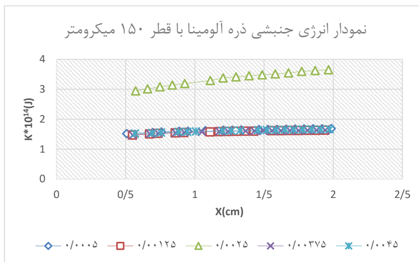
شکل (۴-۱۷) انرژی جنبشی ذره آلومینا با قطر ۱۵۰ میکرومتر
