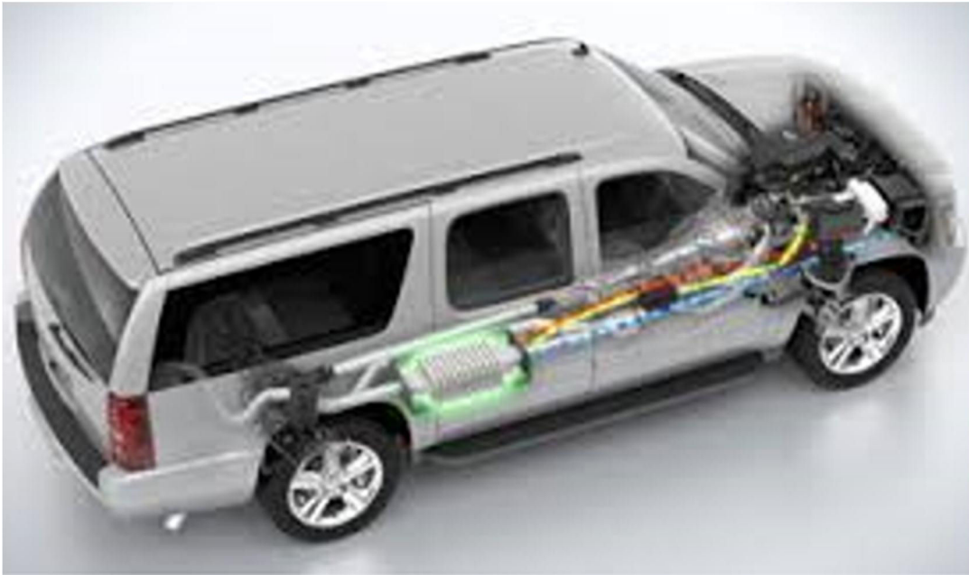
شکل ۲-۱۳ محل نصب المان‌های ترموالکتریک در مسیر طولانی آگروز به منظور تولید الکتریسیته
