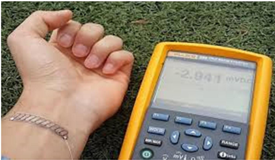
شکل ۲-۱۲ تولید ولتاژ بر اثر اختلاف دما بین محیط و بدن انسان
