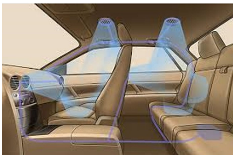
شکل ۳-۶ مکان‌های پیشنهادی نصب کولر و بخاری متحرک ترموالکتریک در خودرو
