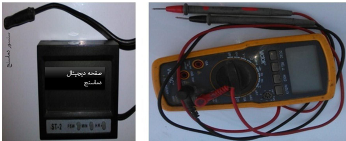
شکل ۳-۷ مولتی متر و دماسنج استفاده شده در اندازه گیری ها
