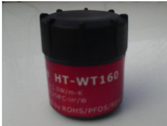
شکل ۳-۱۲ روغن سیلیکون یا گریس گرمایی همراه با کد اختصاری استفاده شده در آزمایش
