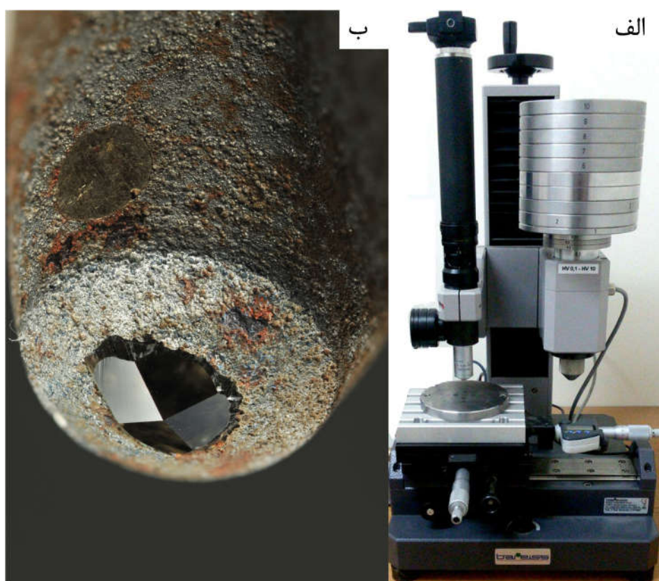
شکل ۲-۹-الف-دستگاه ریزسختی‌سنج پروف‌تشنیک ب- فرورونده‌ی ویکرز
