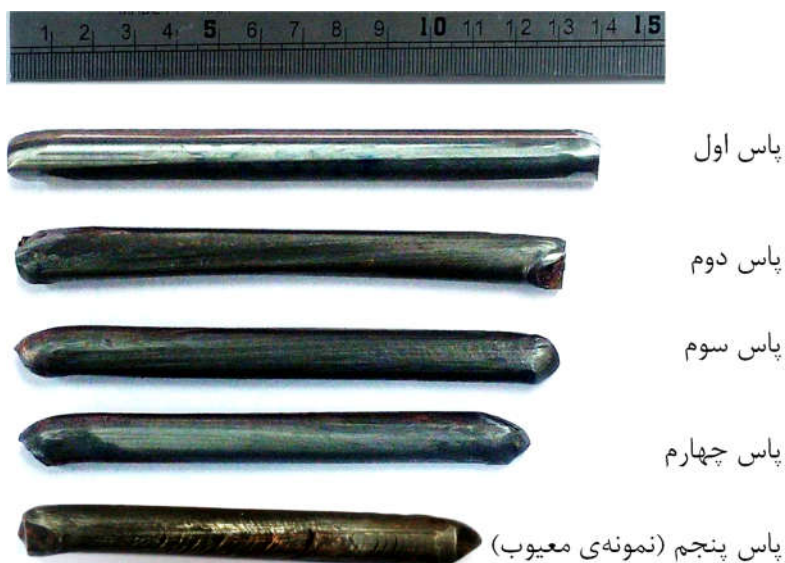
شکل ۳-۲- نمونه‌های تیتانیومی ایکپ شده در دمای 240^{\circ}\text{C}
