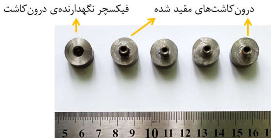
شکل ۳-۱۷- درون کاشت مقید شده درون فیکسچر
