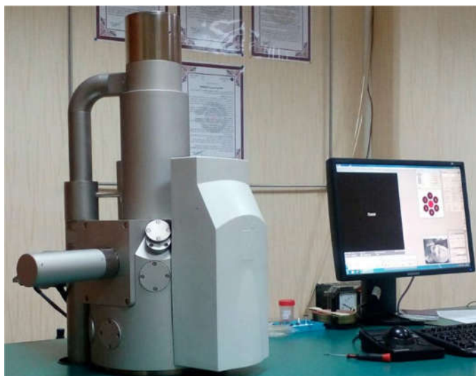
شکل ۲-۱۵- میکروسکوپ الکترونی روبشی شرکت TESCAN
