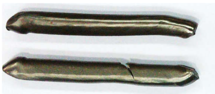
شکل ۲-۴: نمونه‌ی تیتانیومی با قطر اولیه‌ی ۱۱ mm پس از یک مرحله ایکپ در دمای 240^{\circ}\text{C}
