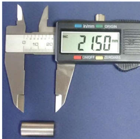
شکل ۲-۱۱- نمونه‌ی تیتانیومی آزمون فشار، آماده شده طبق استاندارد ASTM E9
