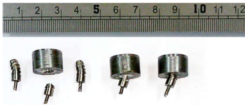
شکل ۳-۱۹- درون کاشت شکسته شده پس از آزمون استحکام مکانیکی
