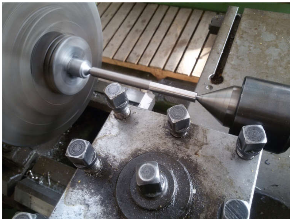
شکل ۲-۳- ماشینکاری نمونه‌ی تیتانیومی با روش مرغک-مرغک
