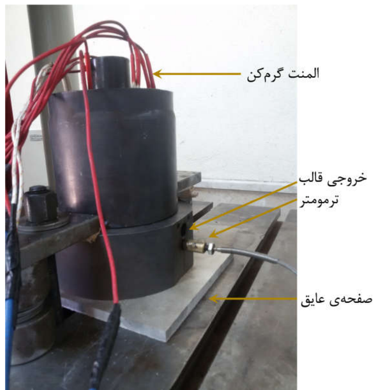
شکل ۲-۲- قالب ایکپ استفاده شده در پژوهش
