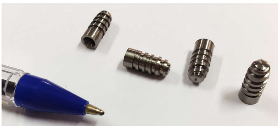
شکل ۳-۱۶- ساخت درون کاشت مهندسی معکوس شده از شرکت DIO
