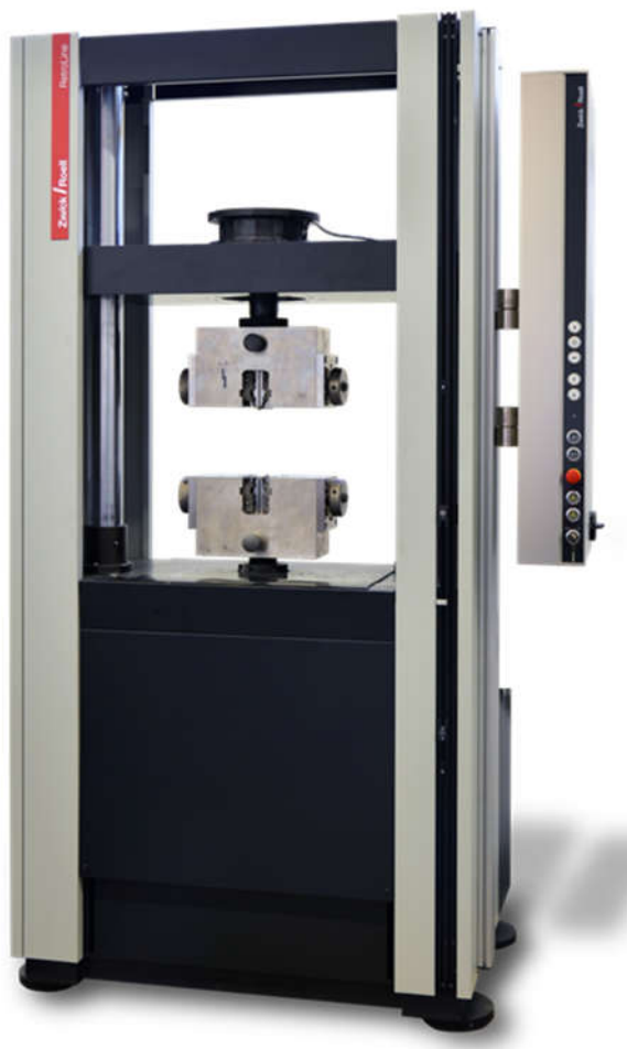
شکل ۲-۱۲- دستگاه آزمون کشش-فشار Zwick 1494
