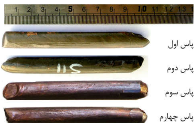
شکل ۱-۳- نمونه‌های تیتانیومی ایکپ شده در دمای 260^{\circ}\text{C}
