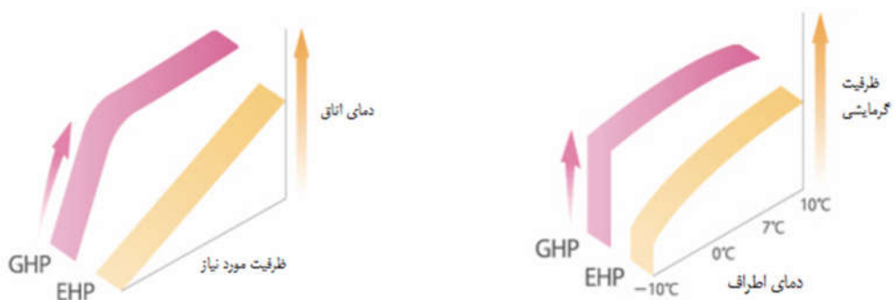
شکل (۱۴-۱) الف: نمودار مقایسه‌ای عملکرد سیستم‌های GHP و EHP در حالت گرمایشی؛ ب: نمودار مقایسه‌ای عملکرد سیستم‌های GHP و EHP در حالت سرمایشی
