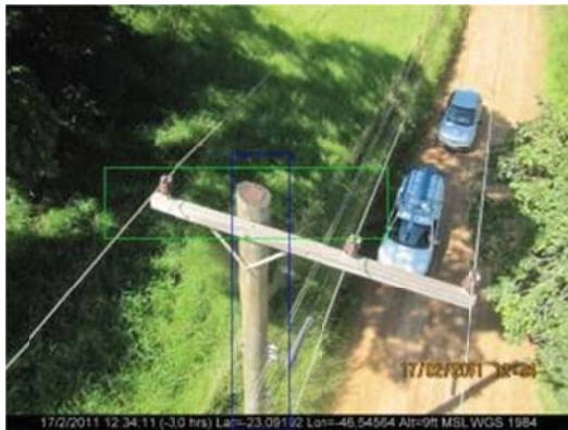
شکل (۱-۲) عملکرد صحیح بینایی ربات پرنده در تشخیص تیر برق و کراس آرم [۳] شکل (۲-۲) عملکرد ناصحیح بینایی ربات پرنده در تشخیص کراس آرم در تصویر [۳]
