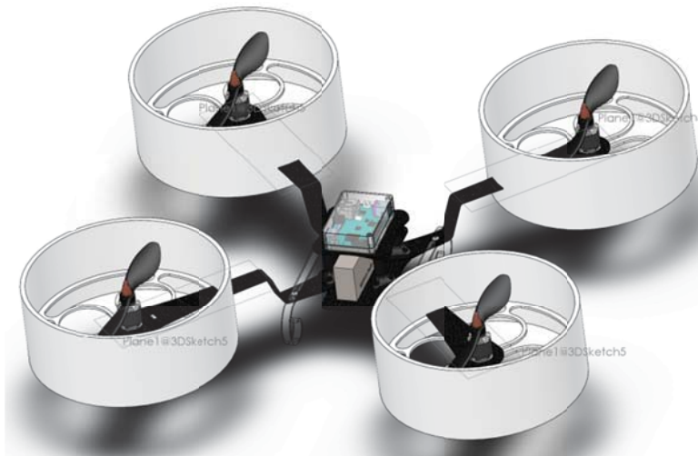
شکل (۳-۱۰) کوادکوپتر طراحی شده جهت بازرسی از خطوط فشار قوی
