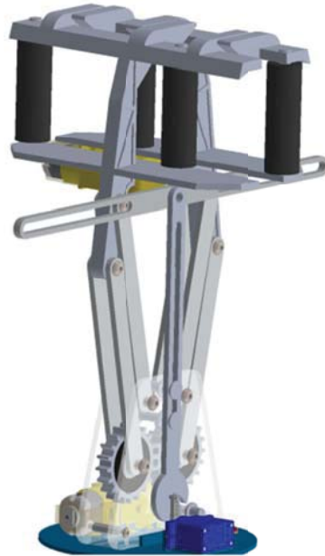
شکل (۳-۳) گیره نگهدارنده طراحی شده جهت اتصال کوادکوپتر به هادی محافظ شبکه انتقال (در حالت بسته) - نما از روبرو
