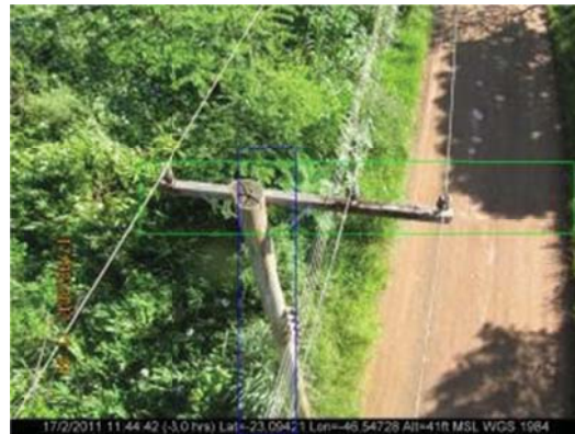
شکل (۱-۲) عملکرد صحیح بینایی ربات پرنده در تشخیص تیر برق و کراس آرم [۳] شکل (۲-۲) عملکرد ناصحیح بینایی ربات پرنده در تشخیص کراس آرم در تصویر [۳]
