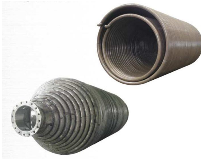
شکل (۲-۵) لوله‌های مارپیچ درون پوسته مبدل
