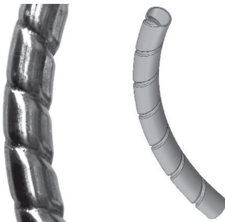
شکل (۲-۱۲) تصویر و شماتیک شیارها ایجاد شده روی کوپل مارپیچ
