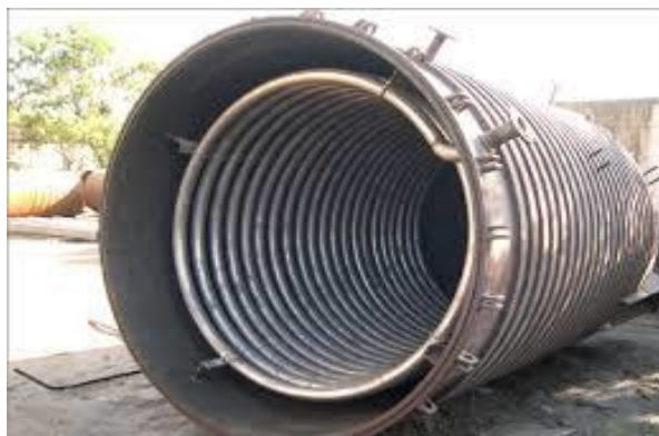
شکل (۲-۴) مبدل حرارتی پوسته و لوله ماریچ
