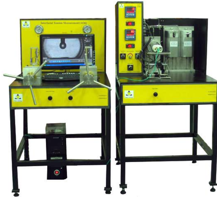
شکل ۳-۶- دستگاه اندازه‌گیری کشش سطحی
