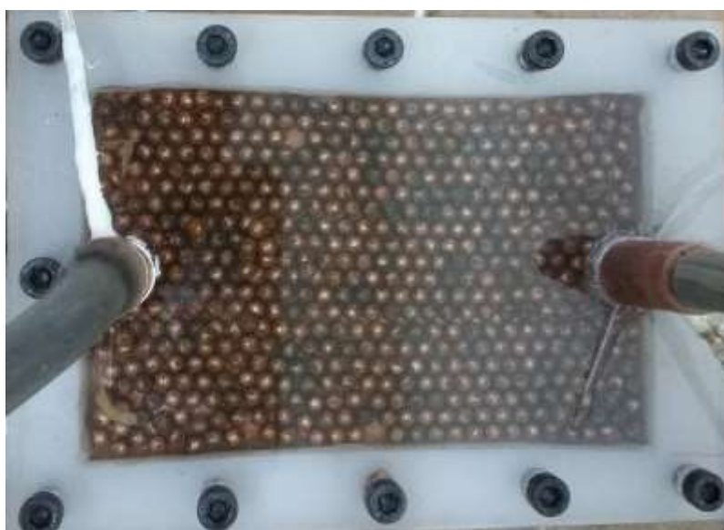
شکل ۱۰-۴: چیدمان ساچمه‌ها داخل چاه حرارتی
