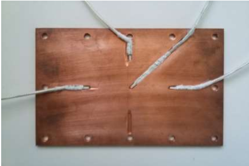
شکل ۴-۱۳: محل قرارگیری حس گرما در کف چاه حرارتی
