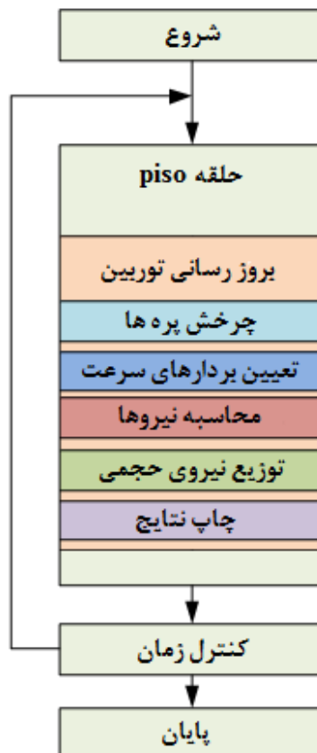
شکل ۳-۱ الگوریتم بکار رفته در برنامه جهت مدل‌سازی با استفاده از حلگر pisoFoam
