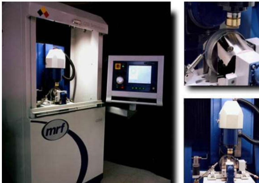
شکل ۱-۸- ماشین پرداخت مگنتورئولوژیکال [۲۳]
