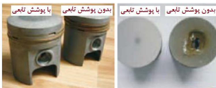
شکل ۲-۴ پیستون موتورهای احتراق داخلی با پوشش تابعی و بدون پوشش تابعی [۳]
