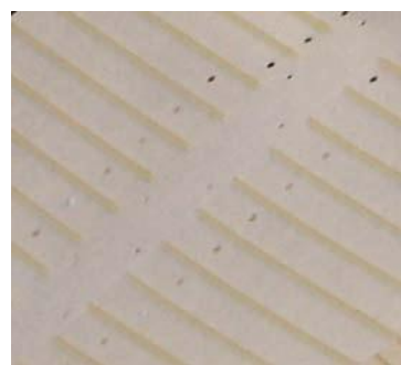
شکل ۲-۲۱ صفحات سلولوزی ترکیبی از چند نوع فیبر (الف) سطح کانال مرطوب و جاذب آب (ب) سطح کانال خشک [۱۸]
