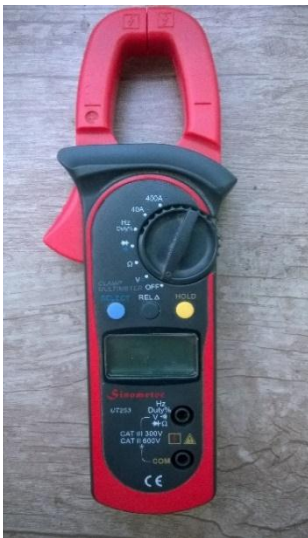
ه) آمپر متر برای اندازه گیری جریان برق
