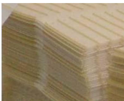
شکل ۲-۲۱ صفحات سلولوزی ترکیبی از چند نوع فیبر (الف) سطح کانال مرطوب و جاذب آب (ب) سطح کانال خشک [۱۸]
