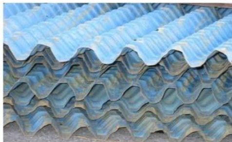
شکل ۲-۲۲ بسترهای تبخیری به‌کاررفته در خنک‌کننده‌های تبخیری غیرمستقیم (الف) فویل آلومینیومی (ب) صفحات پی‌وی‌سی [۱۹]
