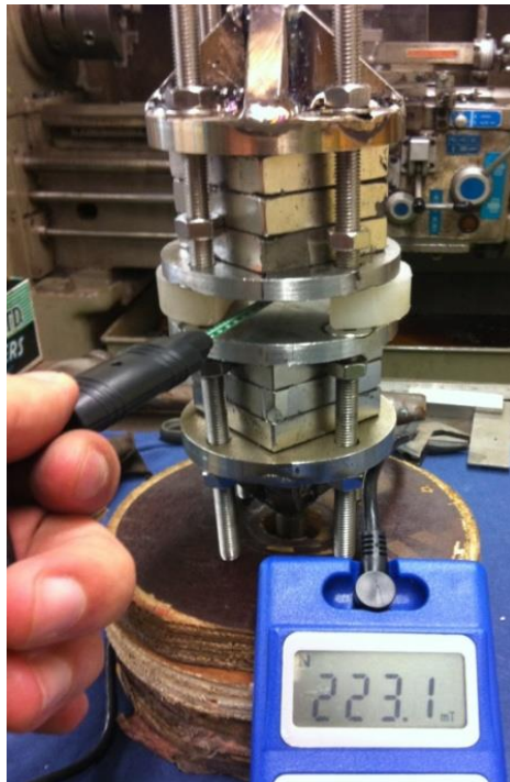
شکل ۲-۷ اندازه‌گیری چگالی شار مغناطیسی بین دو فیکسچر به‌وسیله‌ی تسلامتر
