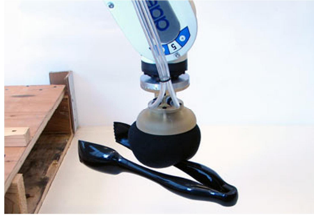
شکل (۹-۱) نمونه از استفاده از پدیده تراکم در پنجه ربات [۳۶]
