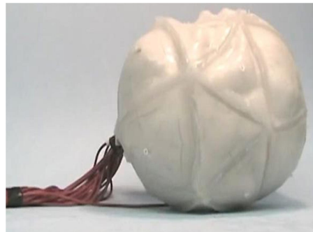
شکل (۸-۱) بازوی پیوسته با پوسته تراکم‌پذیر و استفاده از سیال به عنوان محرک [۳۴]
