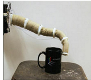
شکل (۱۱-۱) بازوی پیوسته مار شکل با مکانیزم تراکم [۳۲]
