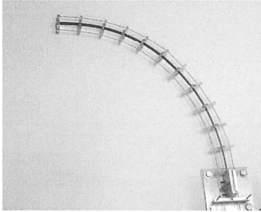
شکل (۲-۱) ربات مار شکل با شش لینک و پنج چرخ [۲] شکل (۳-۱) ستون فقرات بازو پیوسته در دو بعد [۷]
