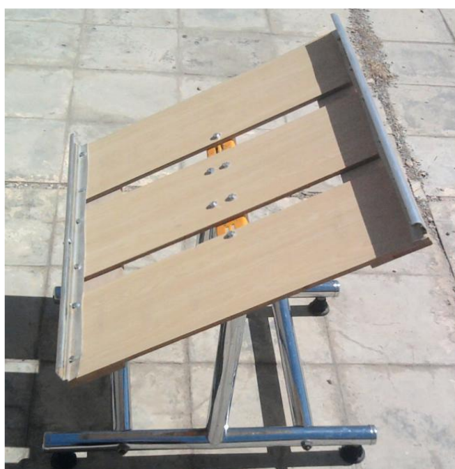
شکل (۳-۵) سازه نگهدارنده تجهیزات فتوولتاییک حرارتی
