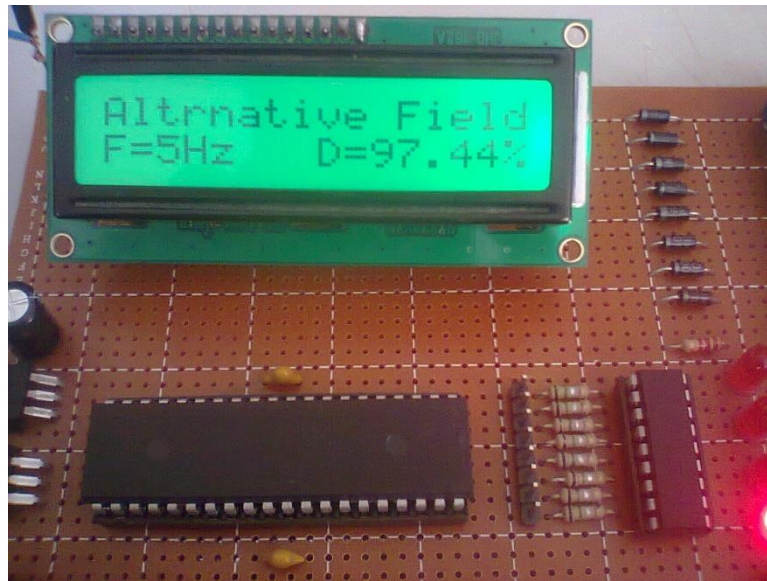
شکل (۵-۱۲) مدار میکروکنترلی تولید کننده میدان مغناطیسی در مد متغیر با فرکانس ۵ هرتز
