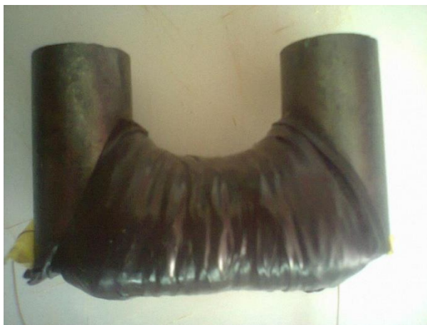
شکل (۵-۱۵) ب هسته فریت سیم پیچی شده جهت اعمال میدان مغناطیسی
