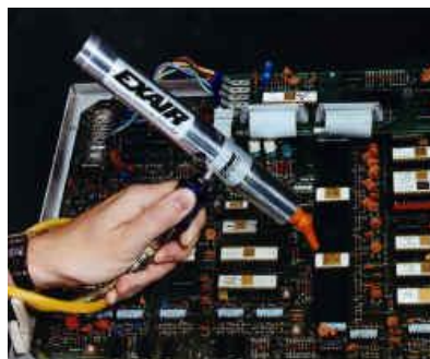
شکل ۱۳-۰۰ خنک کردن قسمتی از کیت الکترونیکی [۵۳]
