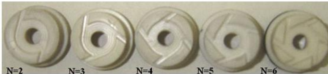
شکل ۶-۰ چند نمونه مبدل گردبادی با تعداد نازل‌های متفاوت [۶]
