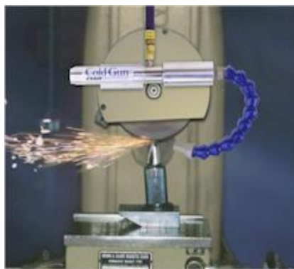
شکل ۱۲-۰۰ خنک کردن تیغه دستگاه برش [۵۳]
