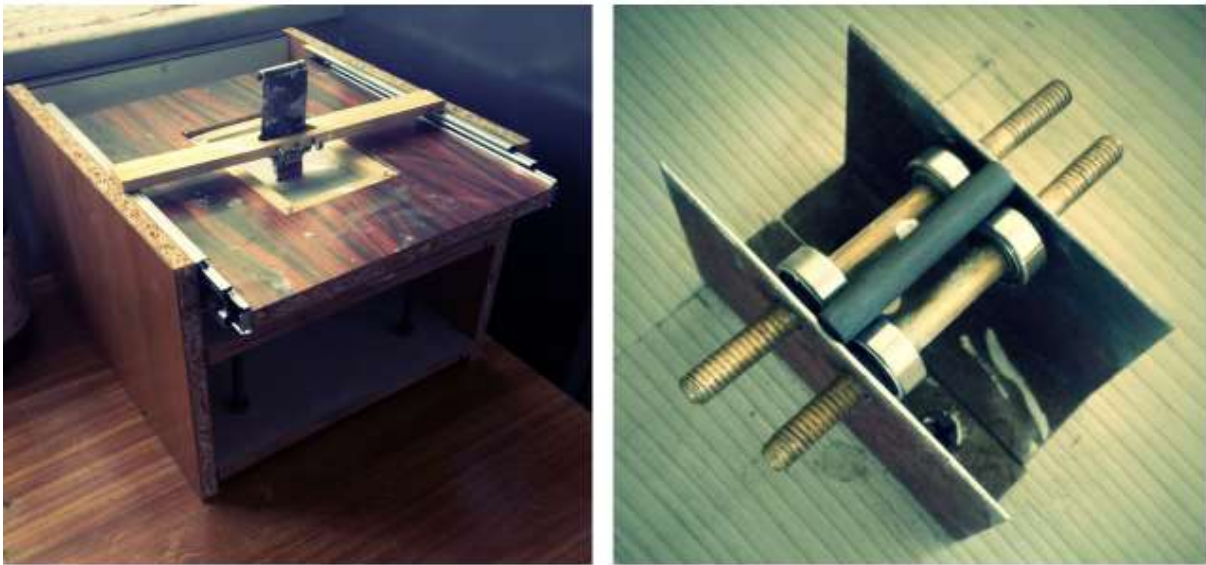
شکل ۲-۱۲: تصویر چیدمان مورد استفاده در ساخت نمونه‌ی لوله‌ی شکل
