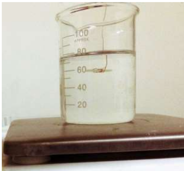
شکل ۲-۱۸: تصویر آزمون چگالی، نمونه غوطه‌ور در آب مقطر
