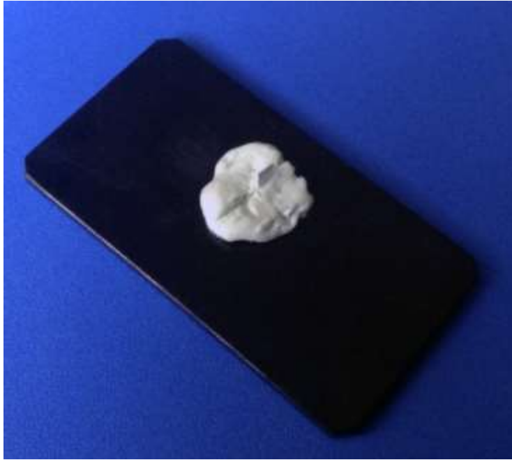
شکل ۲-۱۹: نصب نمونه به صورت عمودی جهت اندازه‌گیری ضخامت نمونه با میکروسکوپ نوری
