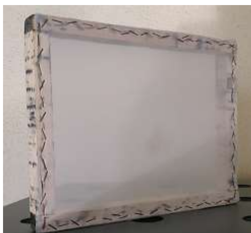
شکل ۲-۴: تصویر قاب چوبی و توری نصب شده روی آن
