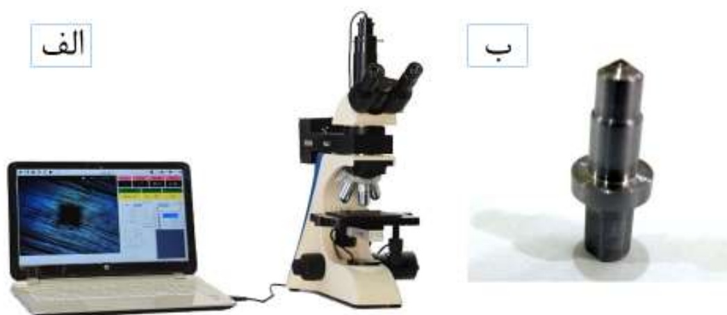
شکل ۲-۲۰: الف) تصویر سختی سنج و ب) هرم سخت فروشونده‌ی ویکرز
