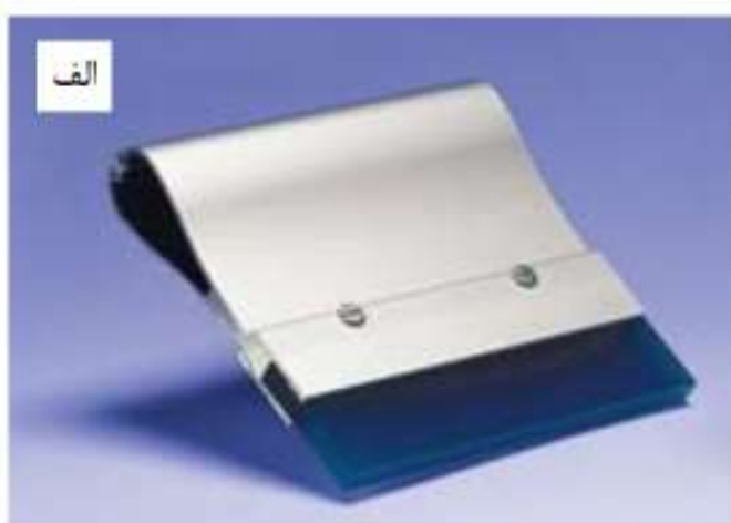
شکل ۲-۵: کاردک؛ الف) کاردک لاستیکی و بدنه، ب) انواع متداول پروفیل قسمت لاستیکی کاردک
