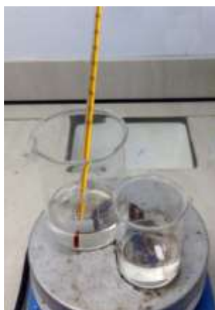
شکل ۲-۲۷: غوطه‌وری نمونه در اسید سولفوریک جوشان (اچ گرم)
