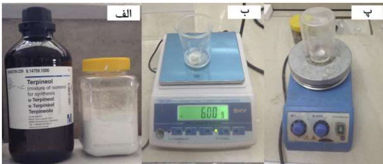
شکل ۲-۲: تجهیزات مورد استفاده در آزمایشگاه؛ الف) پودر YSZ و ترپینوئیل، ب) توزین اجزای خمیر چاپ و پ) هم خوردن مواد روی دستگاه هم‌زن مغناطیسی
