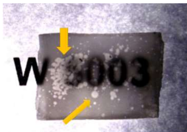
شکل ۳-۸: شفاف شدن بر اثر چگالش کامل و رشد دانه‌ها در دمای 1550^{\circ}\text{C}
