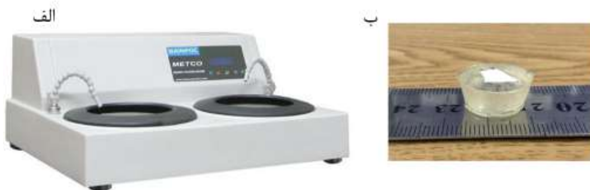
شکل ۲-۱۶: الف) تصویر دستگاه پولیش و ب) نمونه مانت شده
