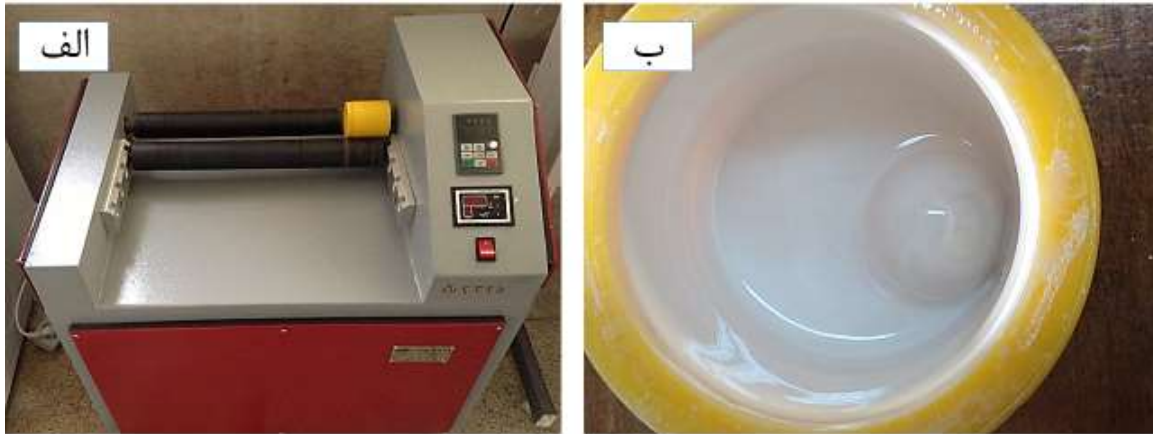
شکل ۲-۳: الف) دستگاه همزن و ب) ظرف از جنس تفلون جهت هم خوردن خمیر چاپ به همراه گلوله از جنس زیرکونیا
