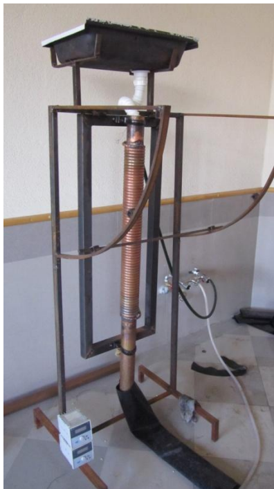
شکل ۱-۲: شماتیک کلی از سازه نگهدارنده مبدل حرارتی
