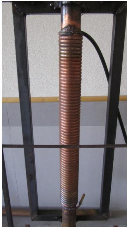
شکل ۲-۵: نصب مبدل و آماده سازی جهت آزمایش
