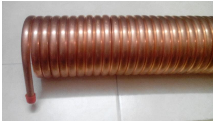
شکل ۲-۴: نمونه ساخته شده نهایی از خم لوله مسی
