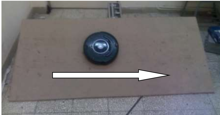
شکل ۶-۲۰ حرکت ربات در راستای سطح شیب‌دار در محیط واقعی
