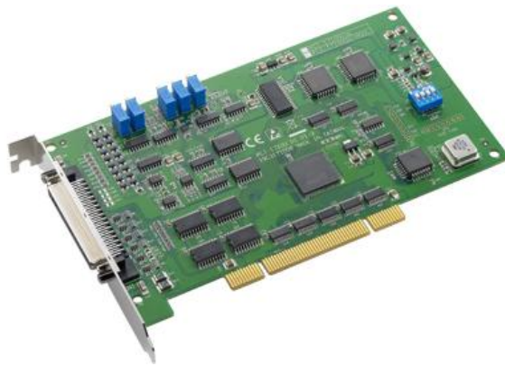
شکل ۸-۵ کارت داده‌گیری PCI-1710
