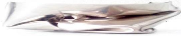
شکل (۹-۲): تغییر شکل پوسته با ارتفاع ۷۰ میلی‌متر و دارای ۱ گشودگی بصورت نامتقارن
