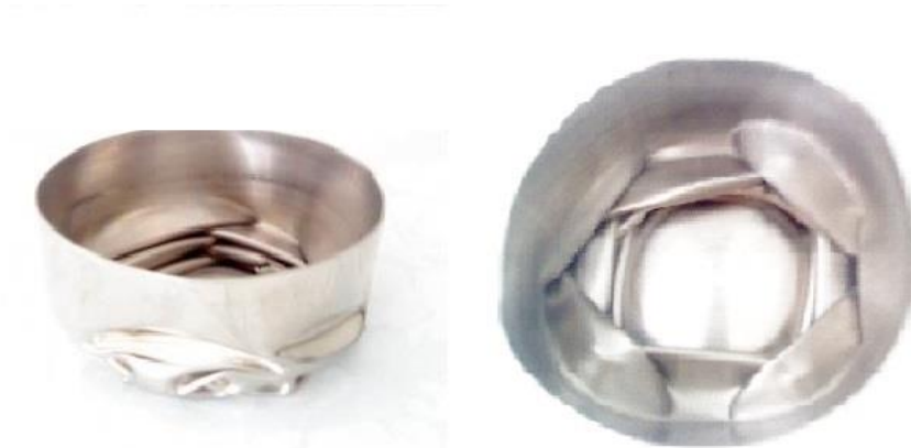
شکل (۸-۲): تغییر شکل پوسته با ارتفاع ۷۰ میلی‌متر و دارای ۲ گشودگی متقارن
