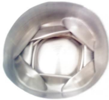
شکل (۲-۲۲): نحوه‌ی جمع‌شدگی قطعه‌ی داری گشودگی در L/3 به قطر ۲۰ میلی‌متر از نمای بالا
