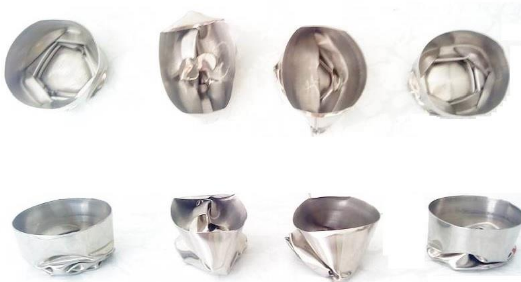
شکل (۲-۲۱): نحوه‌ی جمع‌شدگی ۴ قطعه آزمایش شده بصورت تجربی از نمای بالا و روبه‌رو
