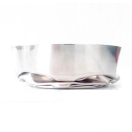
شکل (۲-۲۷): جمع‌شدگی متقارن پوسته‌ی مخروطی با ارتفاع ۱۰۰ میلی‌متر و گشودگی در طول ۰/۳L تحت بارگذاری محوری
