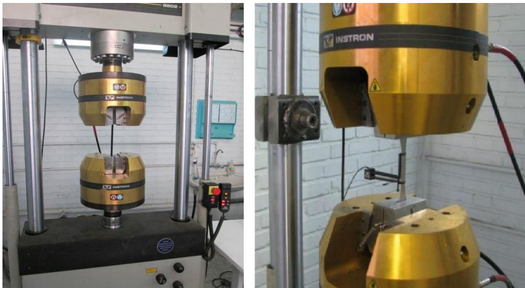
شکل (۲-۱): دستگاه سرو هیدرولیک اینسترون ۸۸۰۲ در حال انجام آزمایش کشش استاندارد
