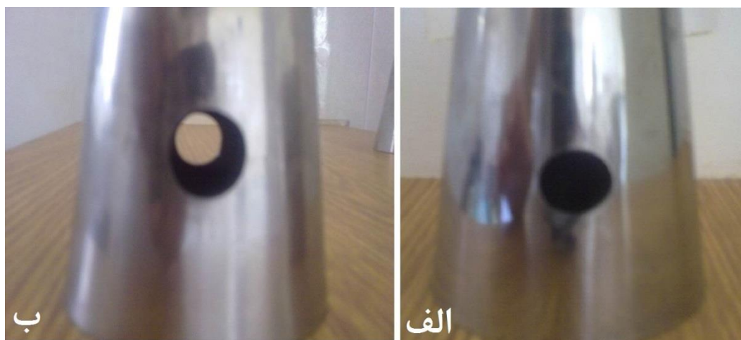
شکل (۲-۱۲): الف- پوسته‌ی ۱۰۰ میلی‌متری با ۱ گشودگی ۱۵ میلی‌متری بصورت نامتقارن ب- پوسته‌ی ۱۰۰ میلی‌متری بصورت نامتقارن ب- پوسته‌ی ۱۰۰ میلی‌متری بصورت متقارن.
