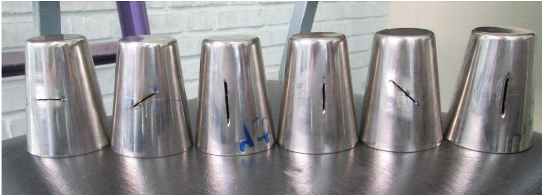
شکل (۳۴-۲): پوسته‌های مخروطی ناقص با شیار به عرض ۱ میلی‌متر در وسط با زاویه‌های به ترتیب صفر (عمودی)، ۴۵ و ۹۰ (افقی) درجه
