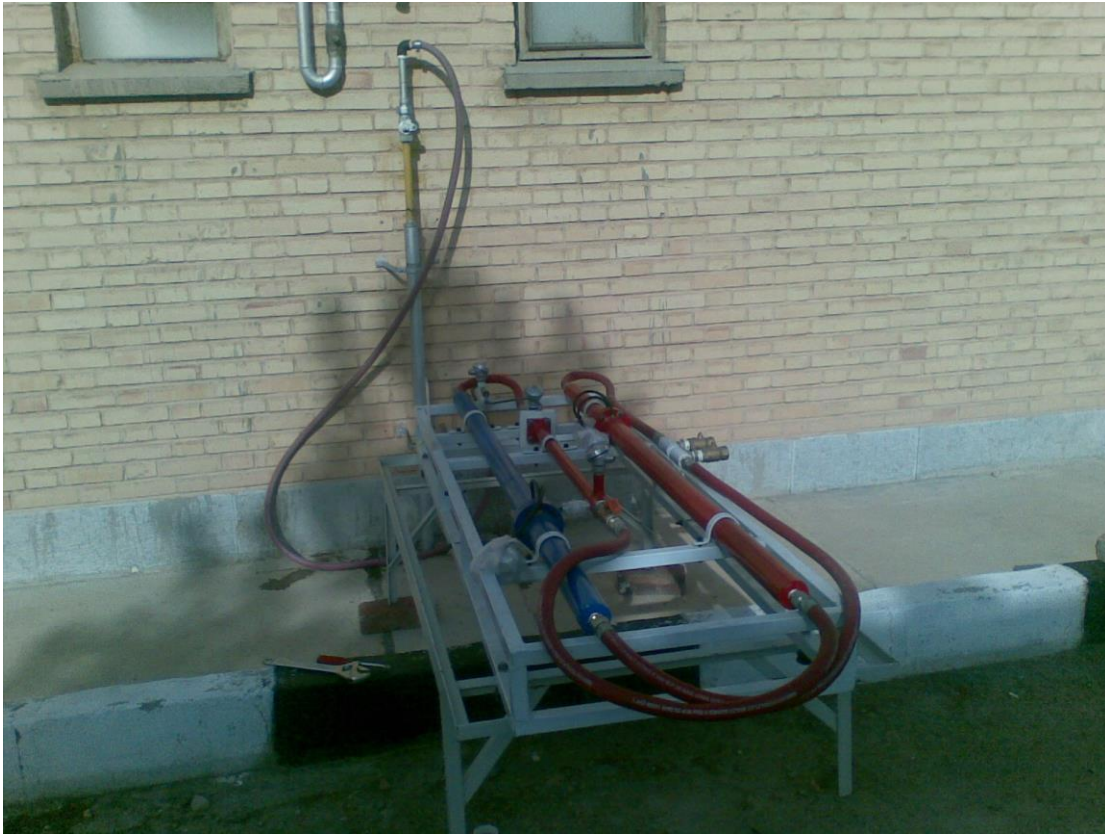
شکل ۴-۷: نحوه اتصال دستگاه به رگلاتور
