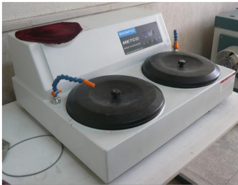
شکل ۳-۷ دستگاه پولیش (METCO)
