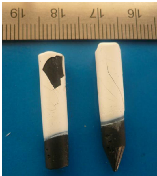
شکل ۳-۳ نمونه‌های ترک خورده حین خشک شدن
