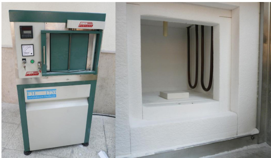
شکل ۳-۶ کوره (Azar Furnaces, Molybdenum Disilicide)
