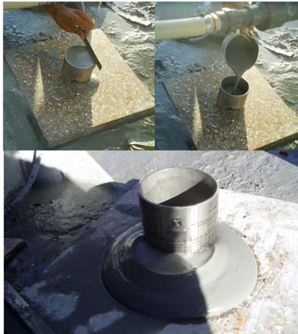
شکل ۳-۷) مراحل انجام آزمایش اسلامپ
