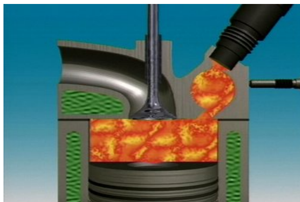
شکل ۴-۱۷ نمای از یک موتور با اتاق احتراق جداگانه
