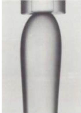
شکل (۳-۱) تورم جت یک سیال ویسکوالاستیک در نزدیکی سر نازل [۳]
