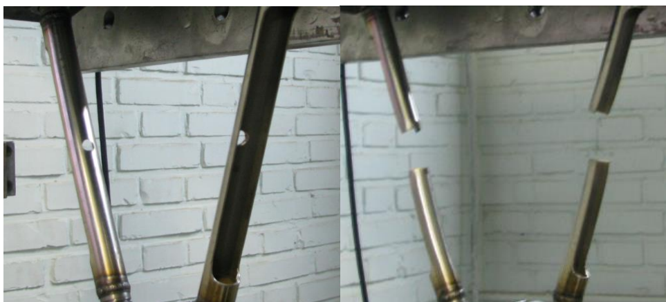
شکل (۲-۲۹) گشودگی دایروی در میانه‌ی پانل استوانه‌ای تحت بارگذاری مرکب تناوبی قبل و بعد از شکست
