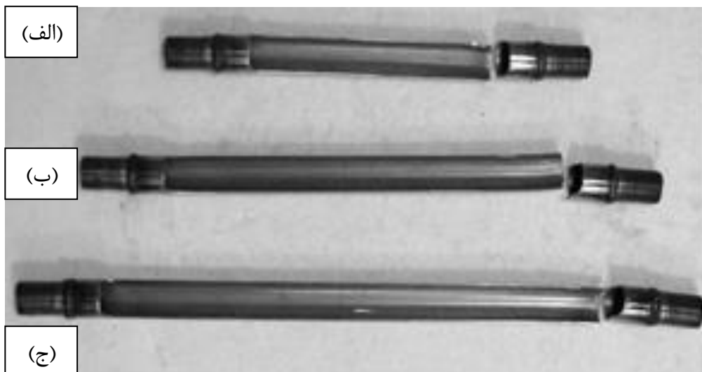
شکل (۲-۱۴) پانل‌های استوانه‌ای آزمایش شده با سه طول مختلف، (الف) طول پانل برابر ۱۷۵ میلی‌متر، (ب) طول پانل
