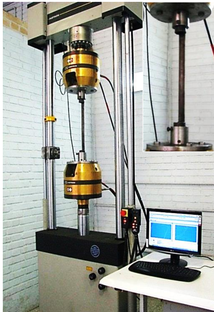
شکل (۲-۳۹) یک نمونه پانل ۹۰ درجه تحت آزمایش از جنس Ck45
