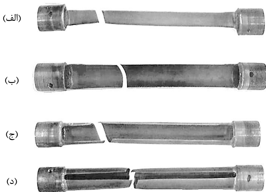
شکل (۲-۴۴) پانل‌های استوانه‌ای آزمایش شده با زوایای الف) ۹۰ درجه، ب) ۱۸۰ درجه، ج) ۲۷۰ درجه، د) ۳۵۵ درجه به طول ۳۶۰ میلی‌متر از جنس Ck45
