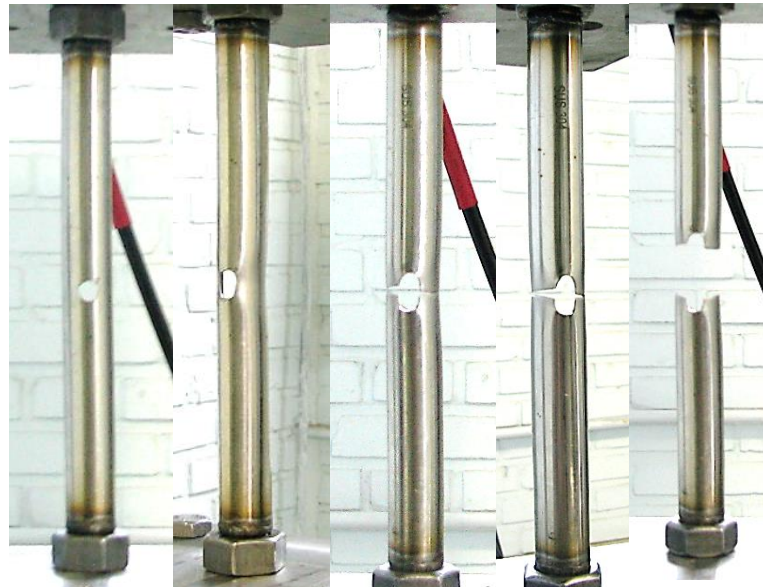
شکل (۲-۳۱) رفتار پانل استوانه‌ای با گشودگی دایروی در میانه‌ی آن تحت بارگذاری محوری تناوبی
