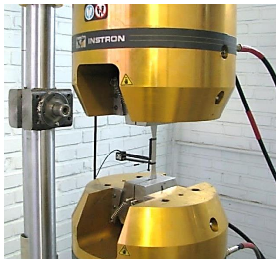
شکل (۲-۲) دستگاه سرو هیدرولیک اینسترون ۸۸۰۲ و استفاده از طول سنج برای آزمایش کشش استاندارد
