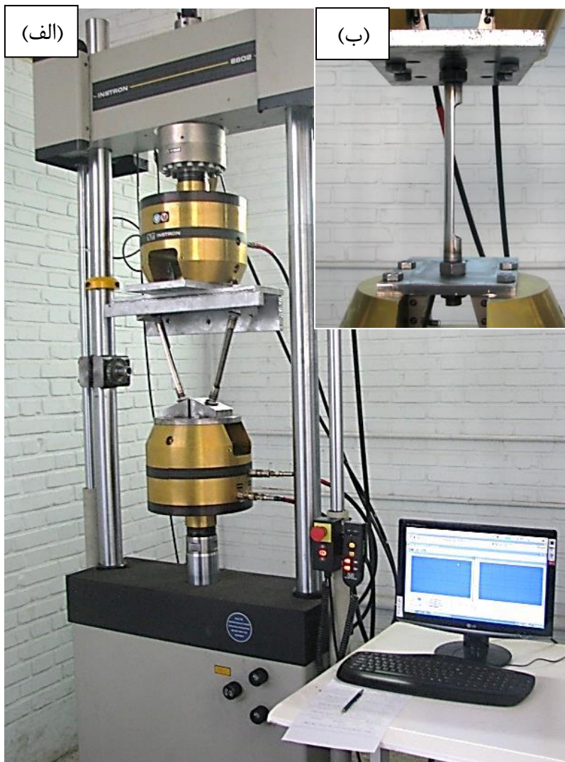
شکل (۵-۲) دستگاه سروهیدرولیک اینسترون ۸۸۰۲، (الف) بارگذاری مرکب، (ب) بارگذاری محوری
