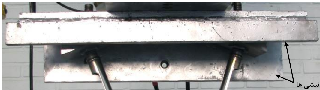
شکل (۸-۲) تقویت صفحه بالایی برای جلوگیری از خمش
