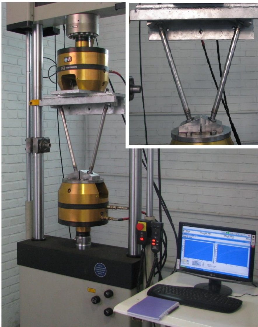
شکل (۷-۳) دستگاه اینسترون و پوسته‌های استوانه‌ای تحت بارگذاری مرکب تناوبی
