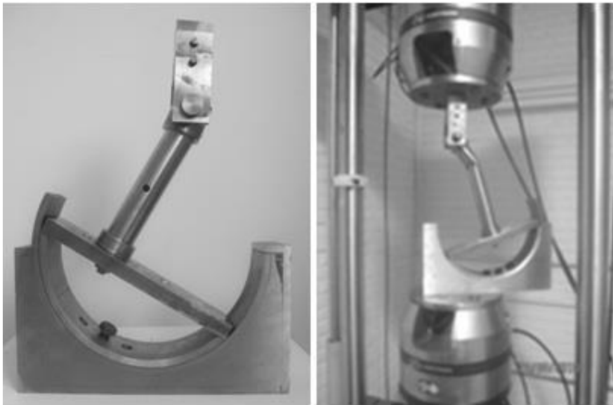
شکل (۴-۶) فیکسچر استفاده شده در حین بارگذاری مرکب بر روی نمونه در آزمایش کمانش در مرجع
