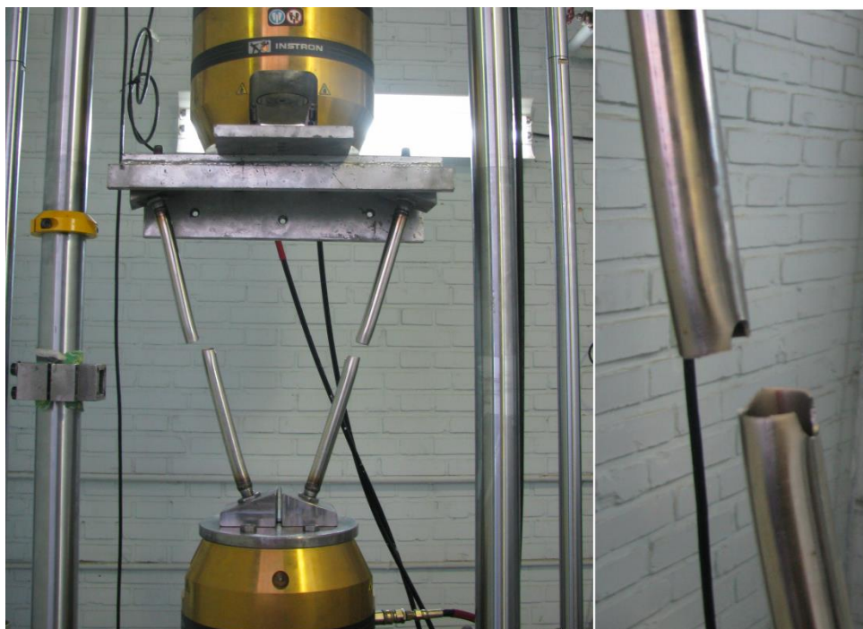
شکل (۳-۲۴) شکست پوسته های استوانه ای با طول مؤثر ۴۰۰mm از محل گشودگی تحت بارگذاری مرکب تناوبی
