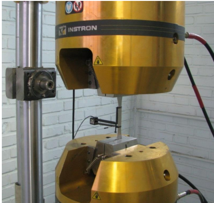
شکل (۱-۳) دستگاه سرو هیدرولیک اینسترون ۸۸۰۲ و استفاده از طول سنج برای تست کشش استاندارد
