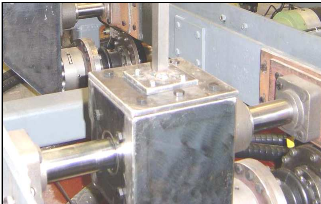
شکل ۳-۶ اتصال پایه پل به میز لرزان [۲۰]
