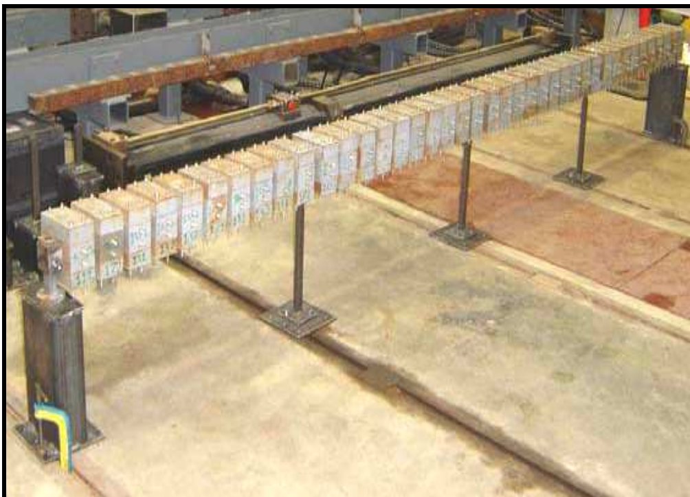
شکل ۳-۵ نمای جانبی مدل پل روی میز لرزان [۲۰]
