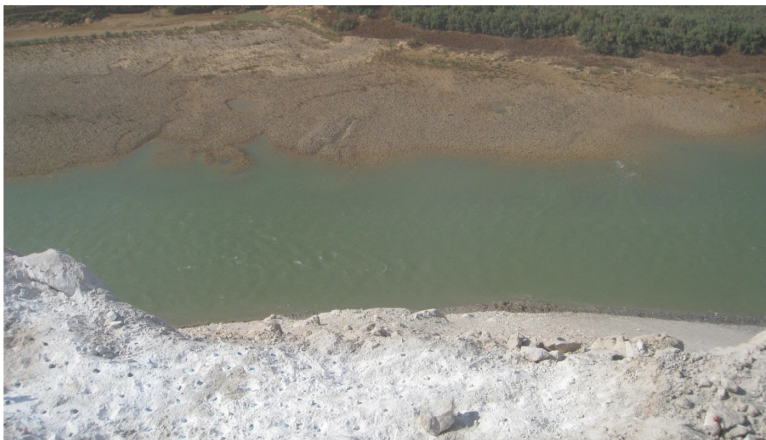
شکل (۳.۳): بلوک‌های نمکی در تراز نزدیک به بستر رودخانه بالادست سد
