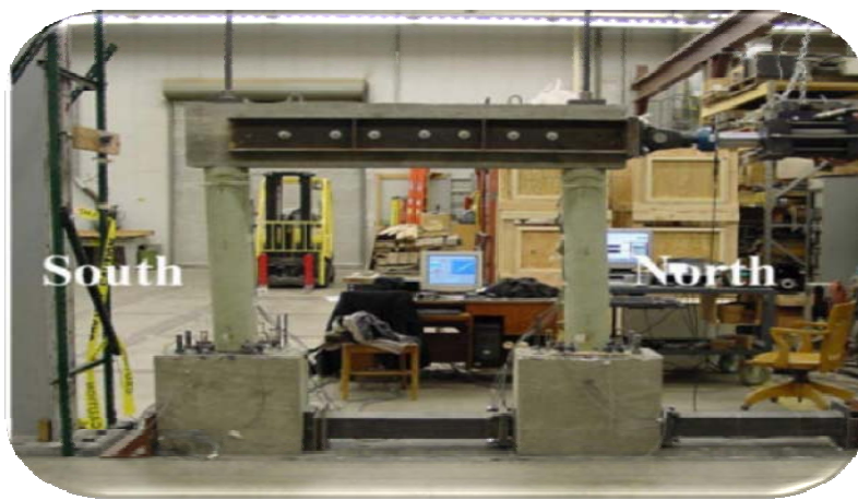
شکل ۳-۱۱: قاب ساخته شده قبل آزمایش [۵۸]
