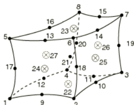
شکل ۴-۱۰: نقاط انتگرال گیری جزء C3D20
