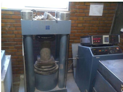
(ب) آزمایش مقاومت فشاری نمونه سیلندری
