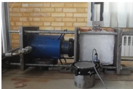
شکل ۳-۱۰- چیدمان آزمایش سه آجره با فشار محوری بعد از تقویت
