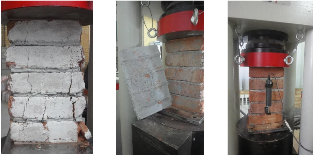
(الف) نحوه تثبیت تغییر مکان سنج (ب) جدایش لایه ECC از نمونه (ج) مود خرابی نمونه بنایی
