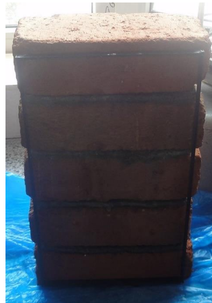
(الف) استفاده از شابلون برای اجرای ملات ECC
