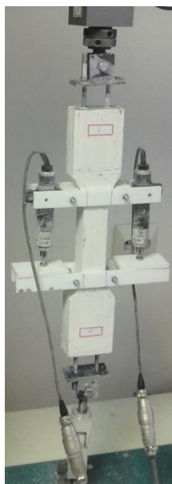
(ب) ابعاد نمونه و چیدمان آزمایش
