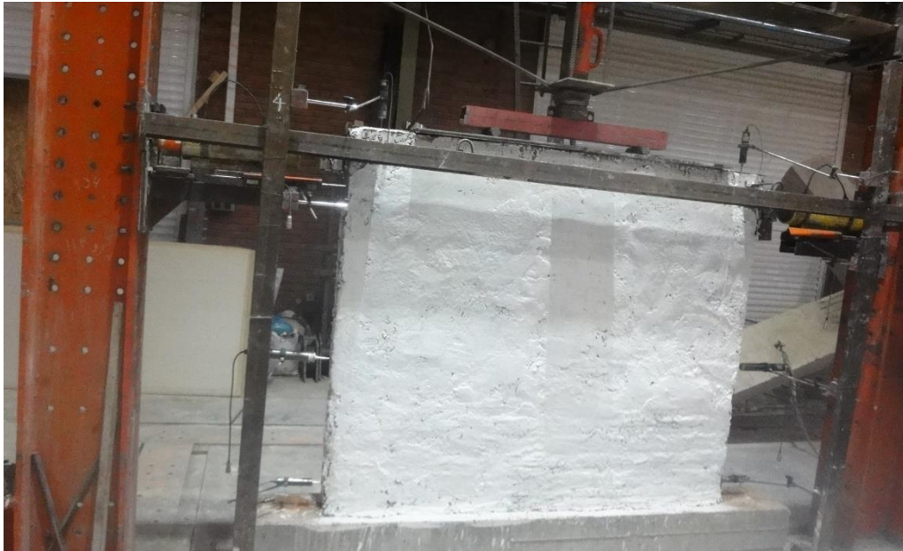
شکل ۴-۹- چیدمان آزمایش و جزییات قرارگیری تجهیزات بارگذاری و اندازه‌گیری نیرو و تغییر مکان (در محل آزمایش)
