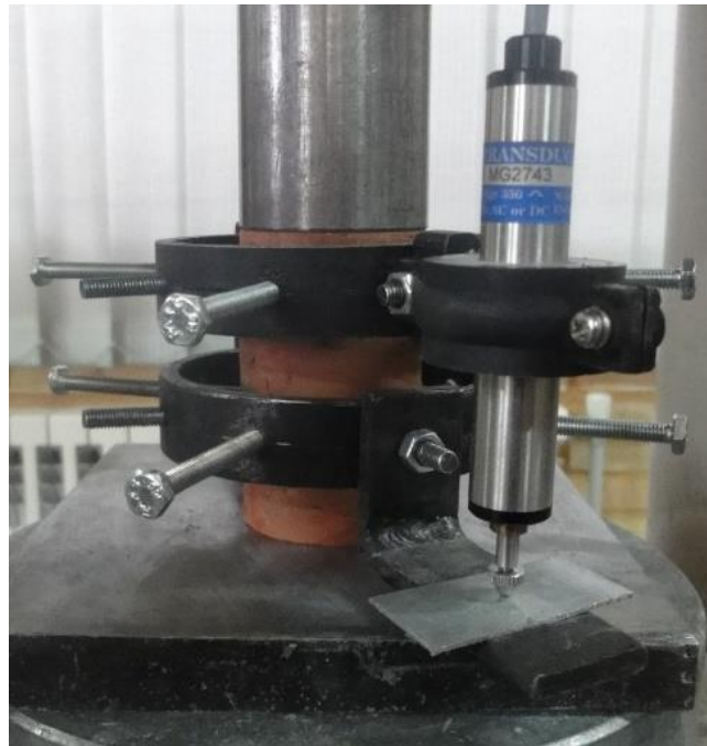
شکل ۲-۲- جزئیات چیدمان آزمایش فشاری تک محوری نمونه‌های استوانه‌ای آجر
