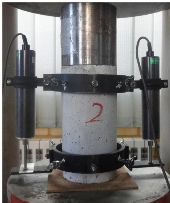
شکل ۲-۵- جزییات چیدمان آزمایش فشاری تک محوری نمونه‌های استوانه‌ای ملات ماسه سیمان
