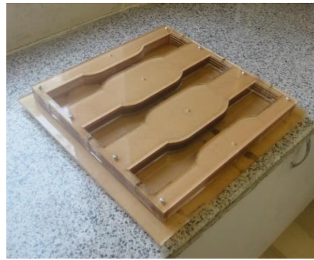
(الف) قالب از جنس پلکسی
