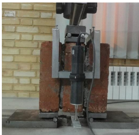
شکل ۳-۹- چیدمان آزمایش سه آجره بدون فشار محوری
