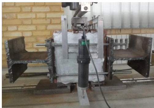
شکل ۳-۱۱- چیدمان آزمایش سه آجره با فشار محوری قبل از تقویت
