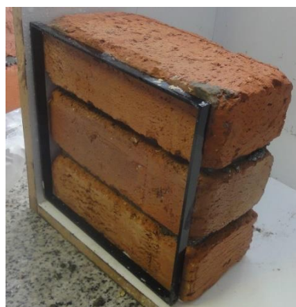
(الف) استفاده از شابلون برای اجرای ملات ECC
