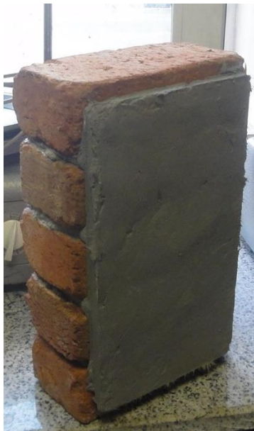
(ب) اجرای ملات ECC روی منشور بنایی
