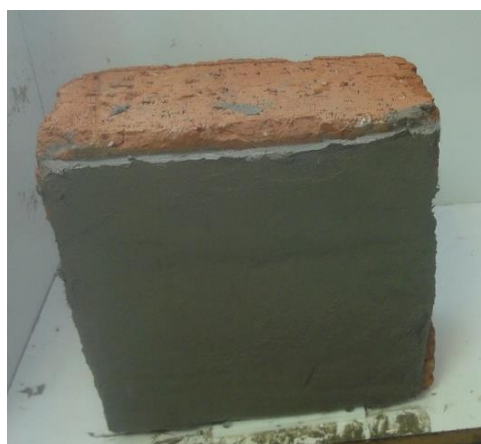
(ب) اجرای ملات ECC روی نمونه بنایی
