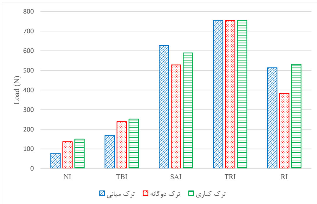
شکل (۴-۵) نیروی گسیختگی در نمونه‌ها (سرعت بارگذاری ۷/۰ میلی متر بر دقیقه)
