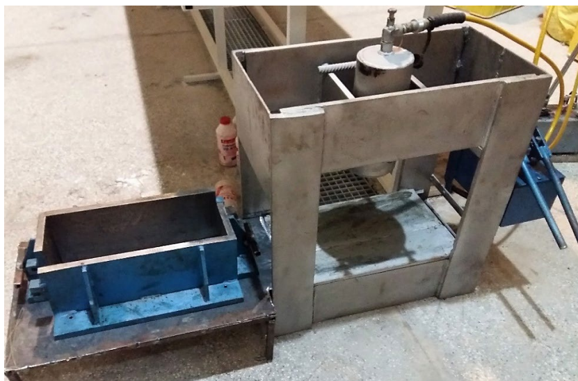
شکل (۴-۴) جک هیدرولیکی و قالب تراکم دال‌های آسفالتی
