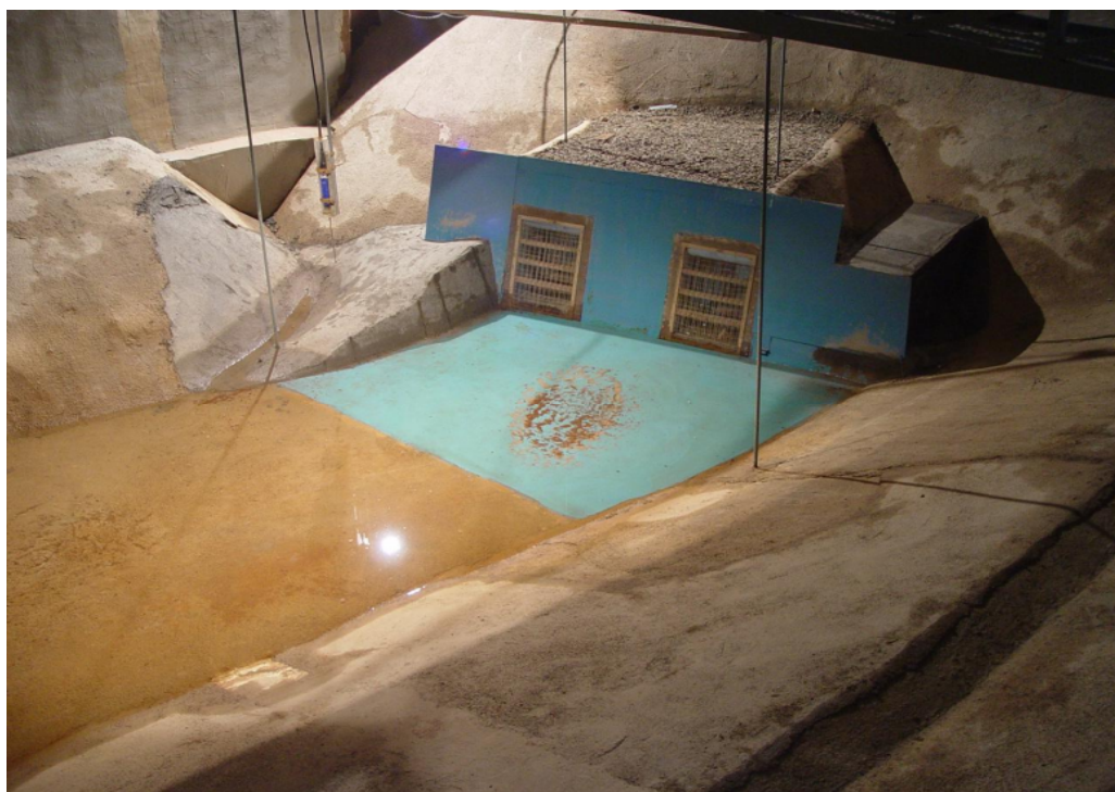
شکل ۴-۱۰-ب تصویر مدل هیدرولیکی آبگیرهای نیروگاه سد سیاه بیشه
