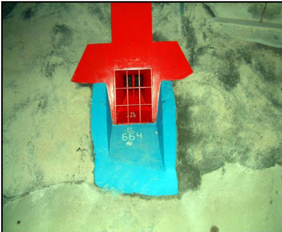
شکل ۴-۹- ب: آبگیر نیروگاه سد سیمره در مدل هیدرولیکی
