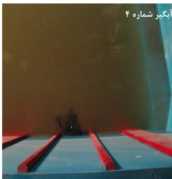
شکل ۴-۱۶- گرداب‌های تشکیل شده در بهره‌برداری از آبگیرها به صورت منفرد در تراز ۱۸۵
