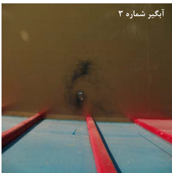
شکل ۴-۱۶- گرداب‌های تشکیل شده در بهره‌برداری از آبگیرها به صورت منفرد در تراز ۱۸۵
