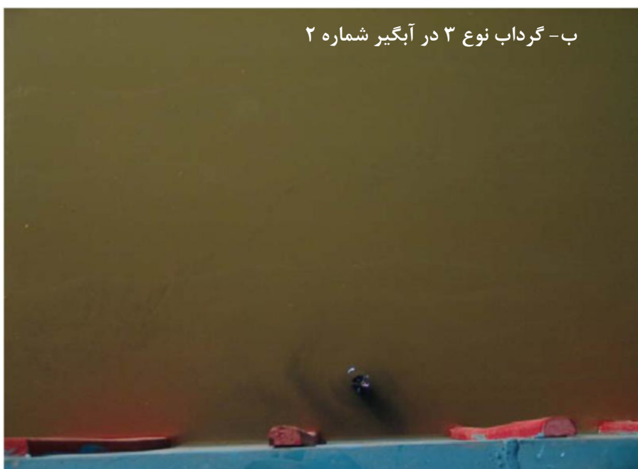
شکل ۴-۱۳- گرداب‌های تشکیل شده در بهره‌برداری همزمان از آبگیرهای ۱ و ۲ در تراز ۱۸۵
