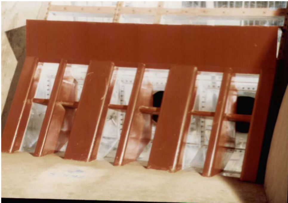
شکل ۴-۸-ب: تصویر مدل هیدرولیکی آبگیرهای نیروگاه سد کارون ۳
