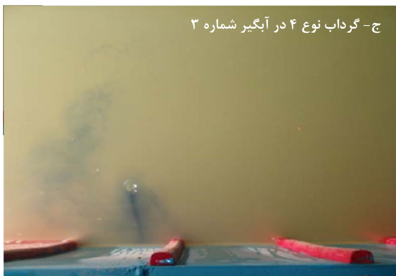
شکل ۴-۱۴- گرداب‌های تشکیل شده در بهره‌برداری همزمان از آبگیرهای ۲ و ۳ در تراز ۱۸۵
