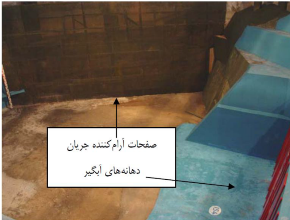
شکل ۳-۵- نمای از مخزن مدل - صفحات مشبک آرام کننده جریان
