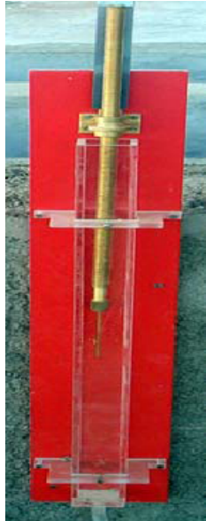
شکل ۳-۸- نمایی از لمینیمتر جهت اندازه‌گیری تراز سطح جریان
