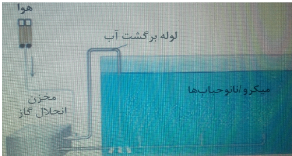
شکل ۲-۷ دستگاه تولید نانوحباب با روش رفع فشار
