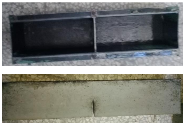
شکل ۳-۱۲: تصاویری از مراحل ساخت نمونه‌های انرژی شکست
