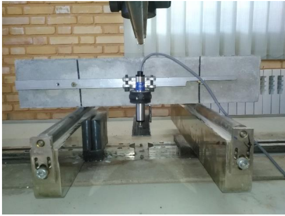
(الف) آزمایش انرژی شکست نمونه با درز (شکل چپ قبل از آزمایش، شکل راست بعد از انجام آزمایش)
