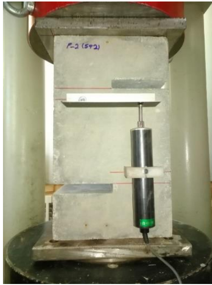
شکل ۳-۳۹: تجهیزات و نحوه بارگذاری آزمایش مقاومت برشی بتن
