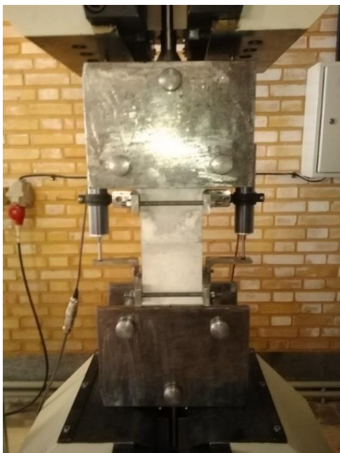
(الف) آزمایش کشش مستقیم نمونه با درز (شکل چپ قبل از آزمایش، شکل راست بعد از انجام آزمایش)
