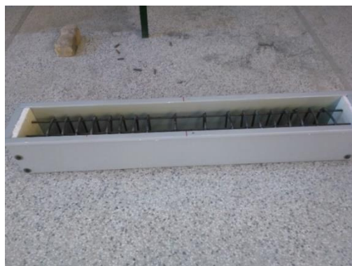
شکل ۳-۱۴: نحوه آرماتوربندی و قرارگیری آرماتورها در قالب تیر
