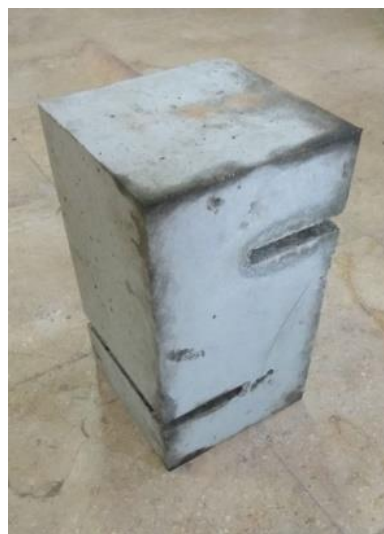
شکل ۳-۱۰: تصاویری از مراحل ساخت نمونه‌های پوش-آف
