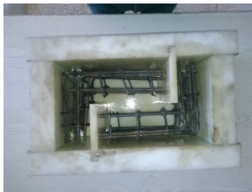
شکل ۳-۹: نحوه آرماتوربندی و قرارگیری آرماتورها در قالب پوش-آف
