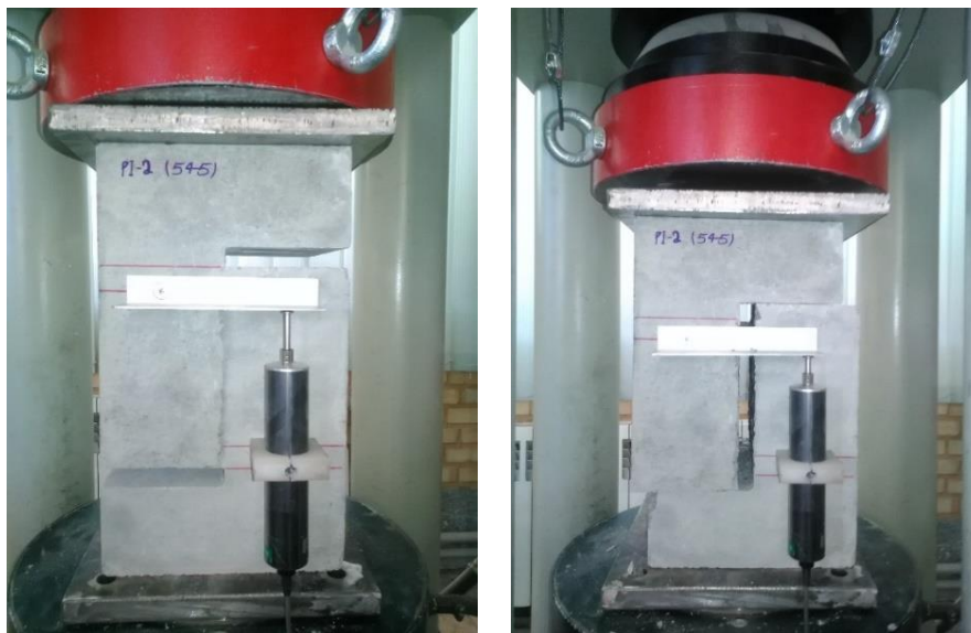
(الف) آزمایش پوش-آف نمونه با درز (شکل چپ قبل از آزمایش، شکل راست بعد از انجام آزمایش)
