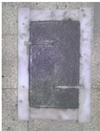
شکل ۳-۱۰: تصاویری از مراحل ساخت نمونه‌های پوش-آف
