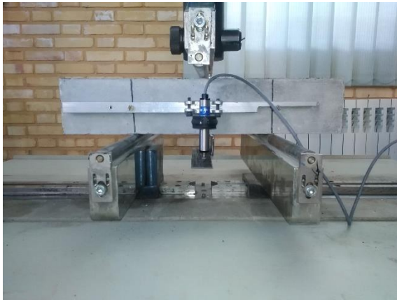
(الف) آزمایش انرژی شکست نمونه با درز (شکل چپ قبل از آزمایش، شکل راست بعد از انجام آزمایش)
