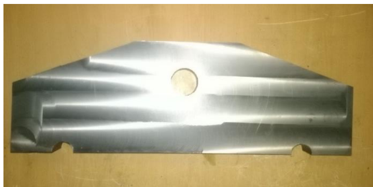
شکل ۳-۴۳: قطعه ساخته شده به منظور آزمایش خمش چهار نقطه‌ای
