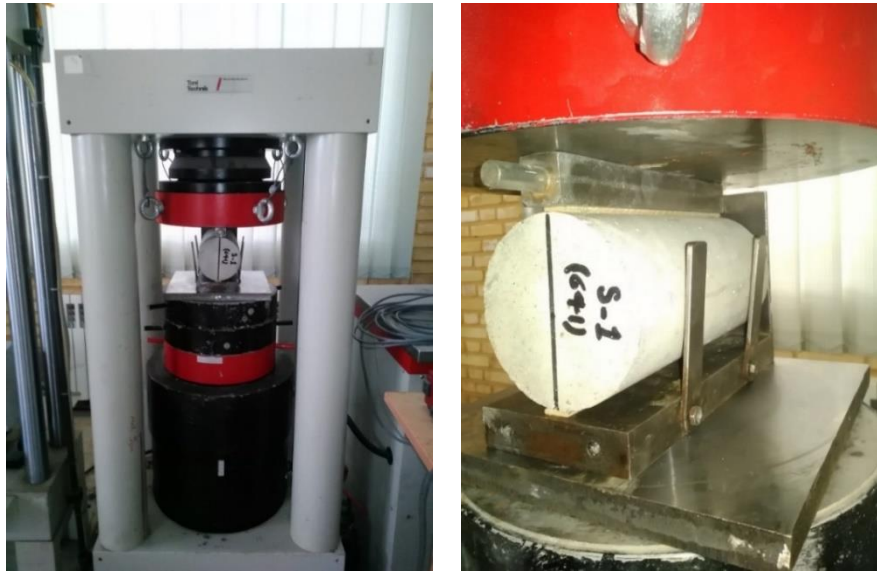
شکل ۳-۳۶: تجهیزات و نحوه بارگذاری آزمایش دونیم‌شدگی
