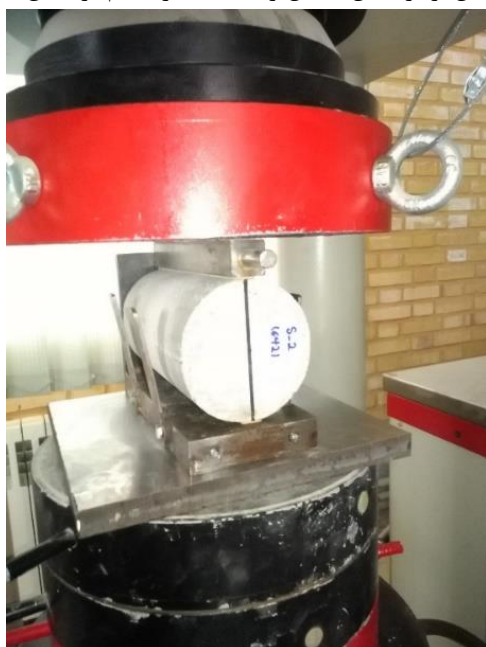
(ب) آزمایش دونیم شدگی نمونه بدون درز (شکل چپ قبل از آزمایش، شکل راست بعد از انجام آزمایش) شکل ۳-۵۰: نمونه‌های آزمایش دونیم‌شدگی (قبل و بعد از آزمایش)
