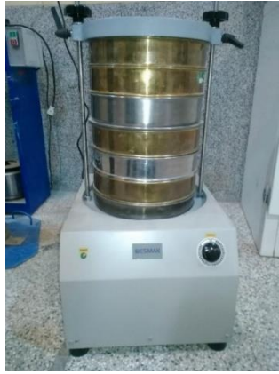
شکل ۳-۱: دستگاه لرزاننده الک برای دانه‌بندی سنگ‌دانه‌ها
