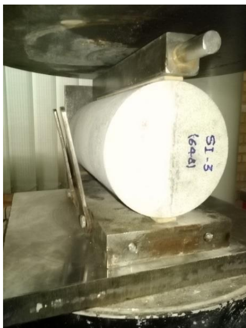
(الف) آزمایش دونیم شدگی نمونه با درز (شکل چپ قبل از آزمایش، شکل راست بعد از انجام آزمایش)
