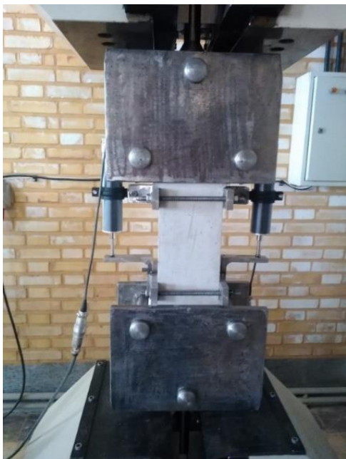
(ب) آزمایش کشش مستقیم نمونه بدون درز (شکل چپ قبل از آزمایش، شکل راست بعد از انجام آزمایش) شکل ۳-۴۹: نمونه‌های آزمایش کشش مستقیم (قبل و بعد از آزمایش)
