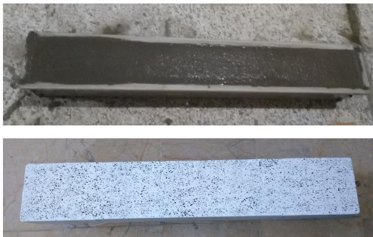
شکل ۳-۱۶: تصاویری از مراحل ساخت تیر بتن مسلح
