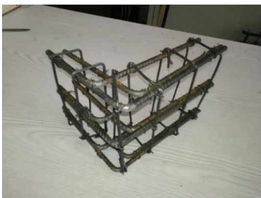
شکل ۳-۹: نحوه آرماتوربندی و قرارگیری آرماتورها در قالب پوش-آف
