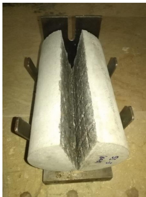
(الف) آزمایش دونیم شدگی نمونه با درز (شکل چپ قبل از آزمایش، شکل راست بعد از انجام آزمایش)
