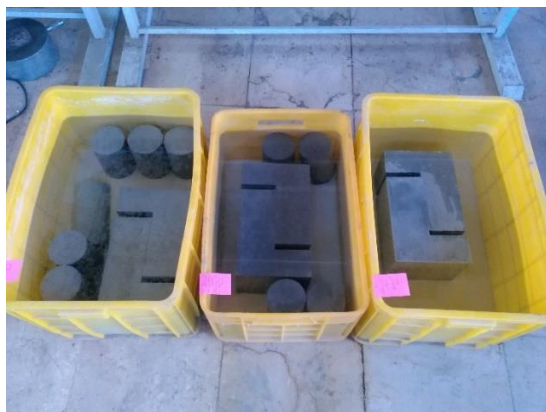
شکل ۳-۱۷: عمل‌آوری نمونه‌های با درز
