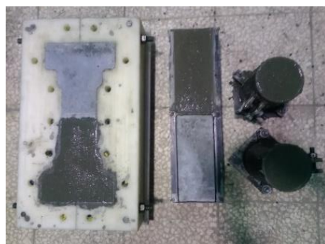
شکل ۳-۲۳: نمونه‌های با درز بعد از بتن‌ریزی دوم
