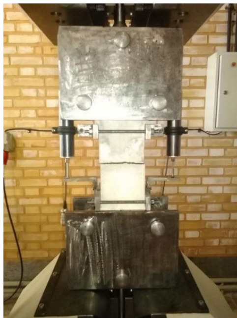
(الف) آزمایش کشش مستقیم نمونه با درز (شکل چپ قبل از آزمایش، شکل راست بعد از انجام آزمایش)
