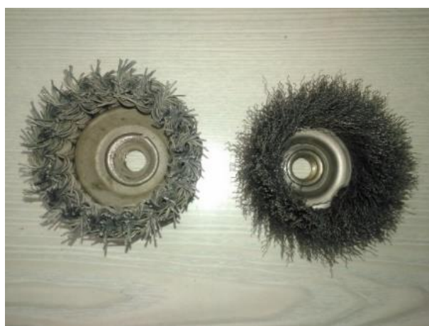
شکل ۳-۲۰: برس‌های سیمی به کار رفته برای زبرسازی سطح بتن بستر
