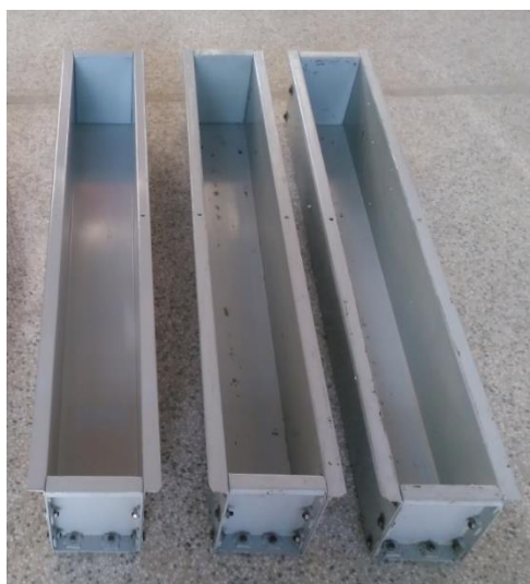
شکل ۳-۱۳: قالب‌های ساخته شده برای تیر
