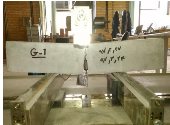
(الف) آزمایش انرژی شکست نمونه با درز (شکل چپ قبل از آزمایش، شکل راست بعد از انجام آزمایش)
