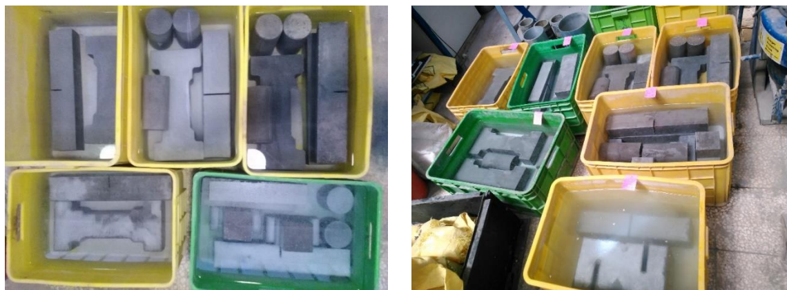
شکل ۳-۵: نمونه‌های یکپارچه در حین عمل‌آوری در آب
