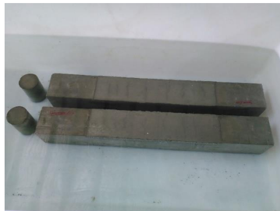
شکل ۳-۱۷: عمل‌آوری نمونه‌های با درز
