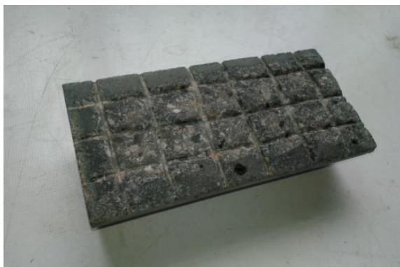
شکل ۳-۲۲: نمونه‌ای از سطح بستر بتن پس از عملیات زبرسازی
