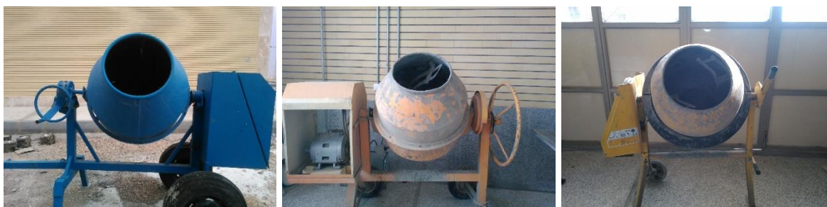
شکل ۳-۴: مخلوط‌کن‌های استفاده شده در ساخت نمونه‌ها
