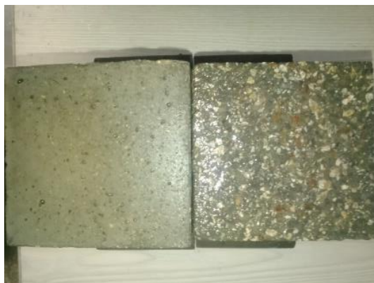
شکل ۳-۲۱: سطح بستر بتن قبل و بعد از عملیات برس‌زنی
