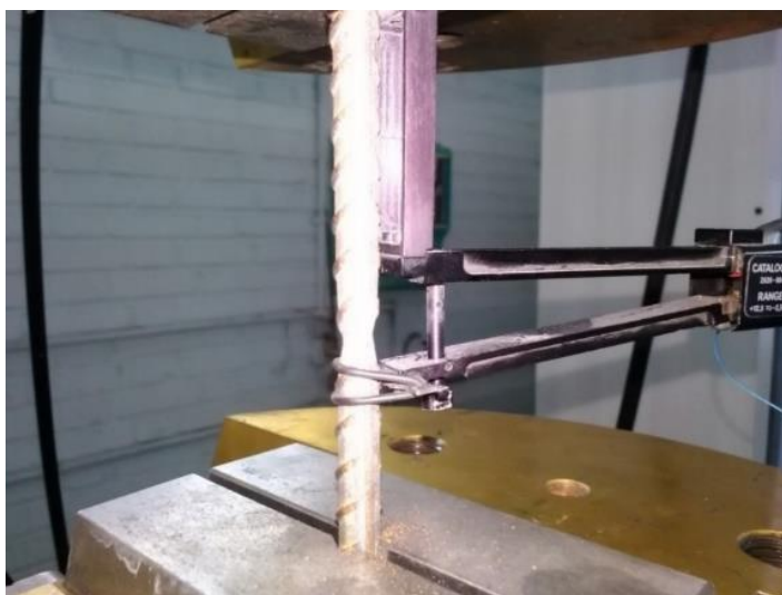
شکل ۳-۵۶: لحظه گلویی شدن میلگرد در آزمایش کشش
