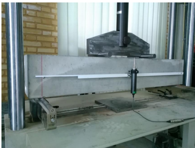
شکل ۳-۴۵: تجهیزات و نحوه بارگذاری آزمایش خمش چهار نقطه‌ای
