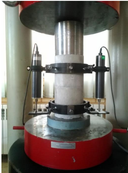
شکل ۳-۳۱: تجهیزات و نحوه بارگذاری آزمایش مدول الاستیسیته
