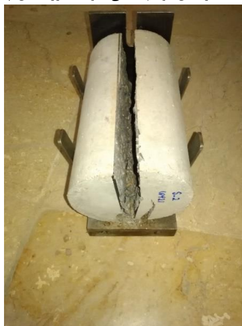
(ب) آزمایش دونیم شدگی نمونه بدون درز (شکل چپ قبل از آزمایش، شکل راست بعد از انجام آزمایش) شکل ۳-۵۰: نمونه‌های آزمایش دونیم‌شدگی (قبل و بعد از آزمایش)
