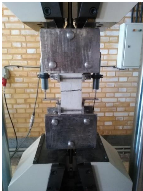
(ب) آزمایش کشش مستقیم نمونه بدون درز (شکل چپ قبل از آزمایش، شکل راست بعد از انجام آزمایش) شکل ۳-۴۹: نمونه‌های آزمایش کشش مستقیم (قبل و بعد از آزمایش)
