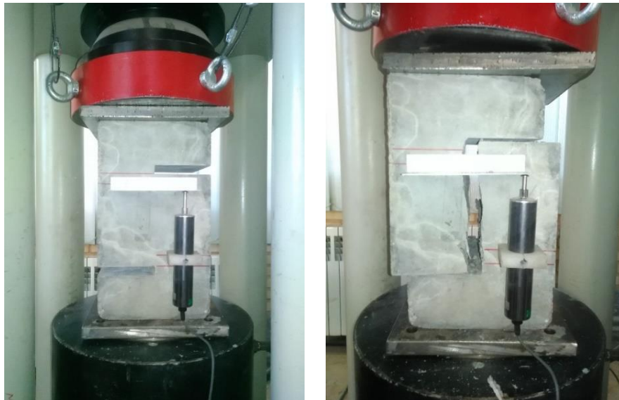
(الف) آزمایش پوش-آف نمونه با درز (شکل چپ قبل از آزمایش، شکل راست بعد از انجام آزمایش)
