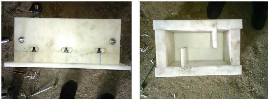
شکل ۳-۸: قالب ساخته شده برای نمونه پوش-آف
