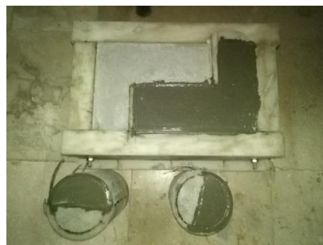
شکل ۳-۲۳: نمونه‌های با درز بعد از بتن‌ریزی دوم
