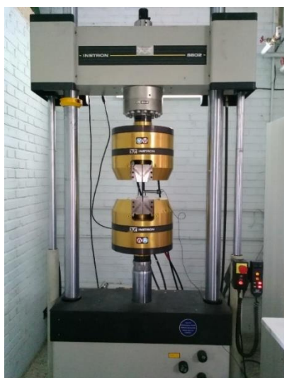
شکل ۳-۴۲: تجهیزات و نحوه بارگذاری آزمایش کشش میلگرد
