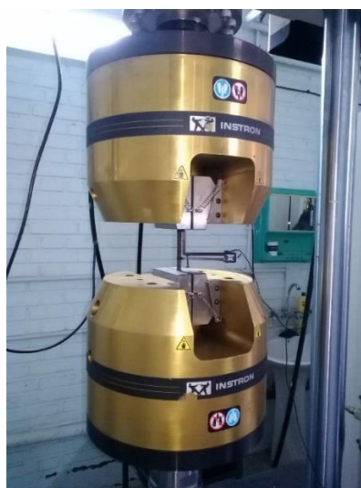
شکل ۳-۴۲: تجهیزات و نحوه بارگذاری آزمایش کشش میلگرد
