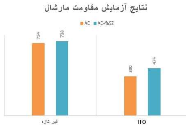
شکل ۴-۱۰- نتایج آزمایش مقاومت مارشال
