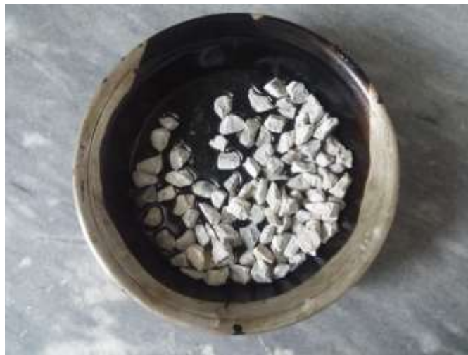
شکل ۳-۷- آزمایش آب جوشان
