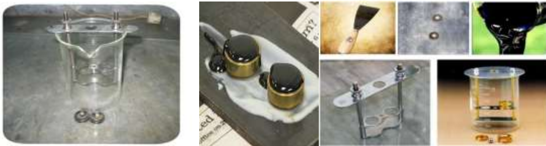
شکل ۳-۳-آزمایش نقطه نرمی
