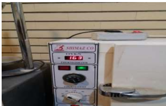
شکل ۳-۶- آزمایش لعاب نازک قیر
