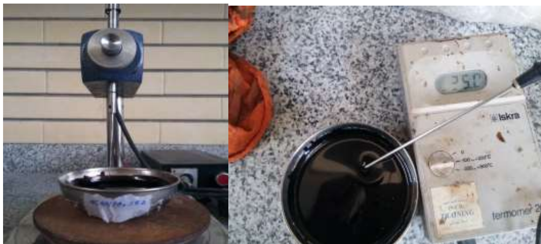
شکل ۴-۱- آزمایش درجه نفوذ
