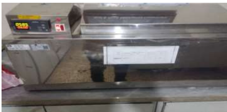
شکل ۳-۱۰- قرار دادن نمونه‌ها در حمام آب گرم
