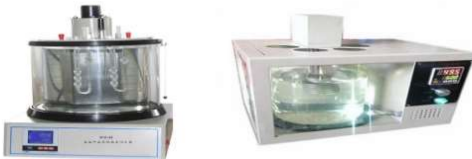
شکل ۳-۵- دستگاه ویسکوزیته کینماتیکی
