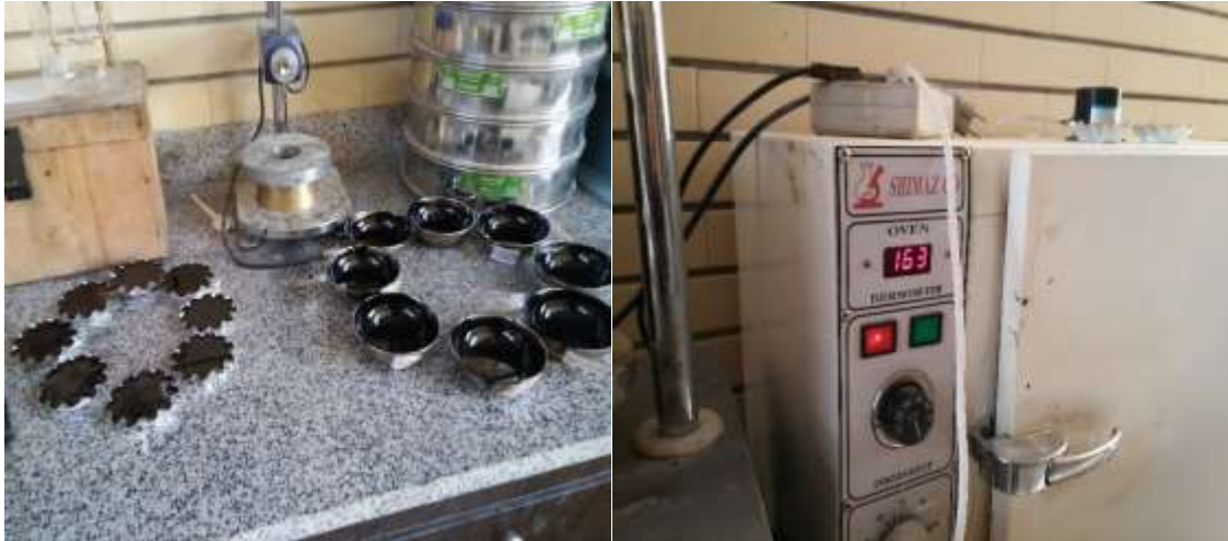
شکل ۴-۳- نمونه‌ها پس از فرسودگی
