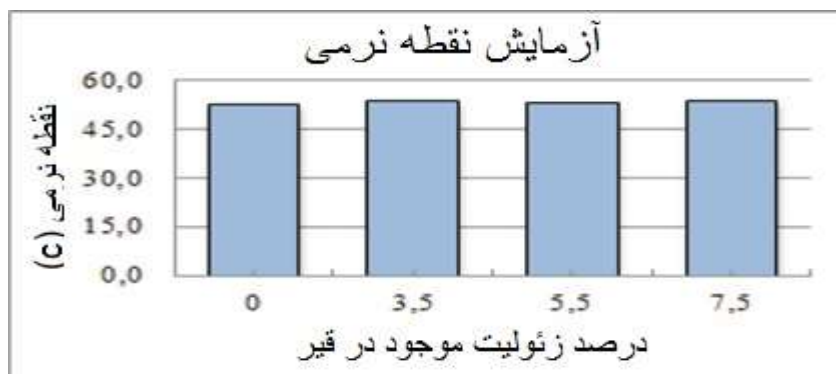
شکل ۲-۴- نتیجه آزمایش نقطه نرمی [۹]
