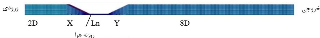
شکل ۳-۲. شماتیکی از لوله ونتوری جهت بررسی تشکیل میکرو حباب
