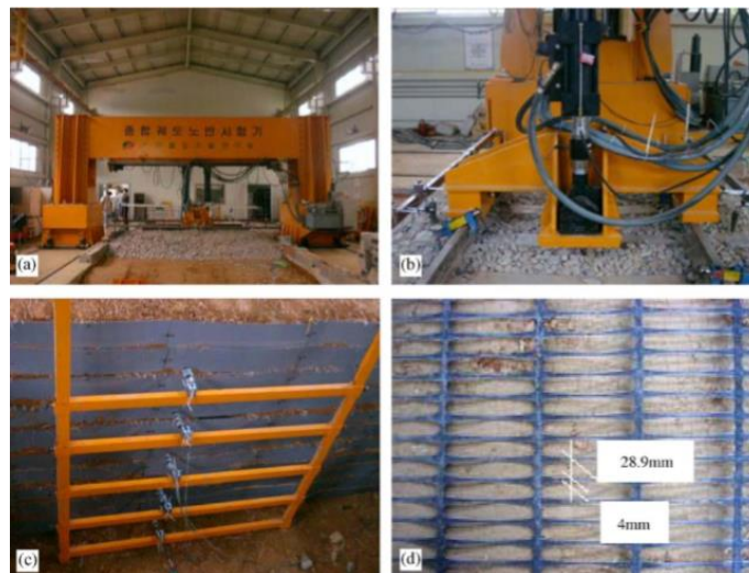
شکل ۲-۱۳ بارگذاری دیواره‌ی خاک مسلح در مجاورت ریل قطار با مقیاس واقعی در پژوهش تان و پارک در سال
