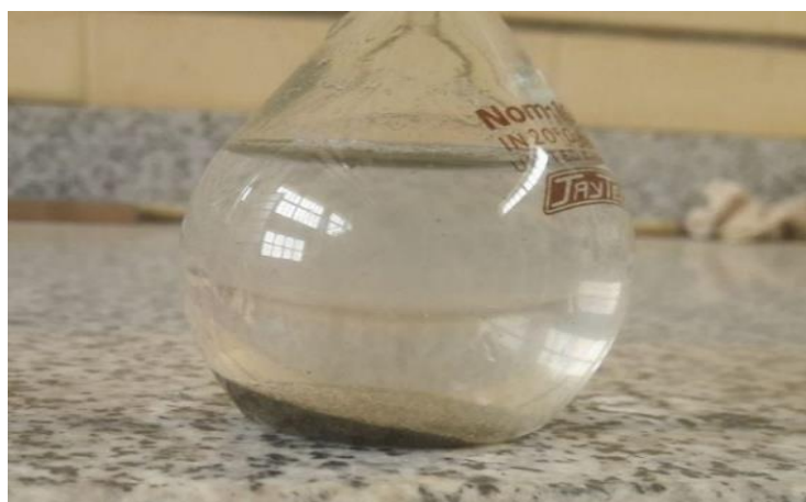
شکل ۳-۴ آزمایش تعیین چگالی ویژه (Gs) خاک ماسه‌ای
