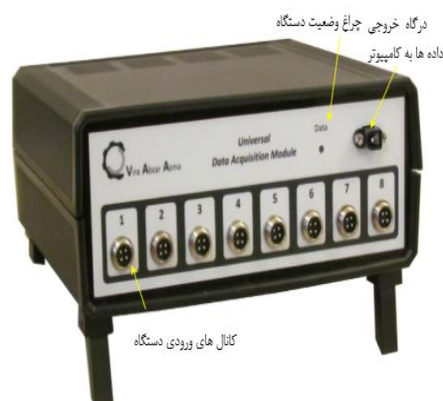
شکل ۳-۸ دیتالاگر و سنسورهای به‌کاررفته در این پژوهش
