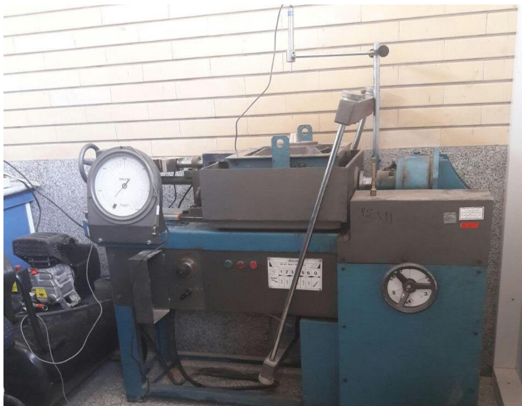
شکل ۳-۷ دستگاه برش مستقیم بزرگ مقیاس آزمایشگاه دانشگاه صنعتی شاهرود ۳
