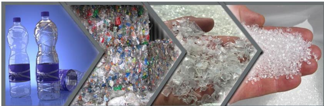
شکل ۲-۸ فرایند بازیافت و تبدیل پت ضایعاتی به گرانول‌های پلیمری قابل ذوب مجدد
