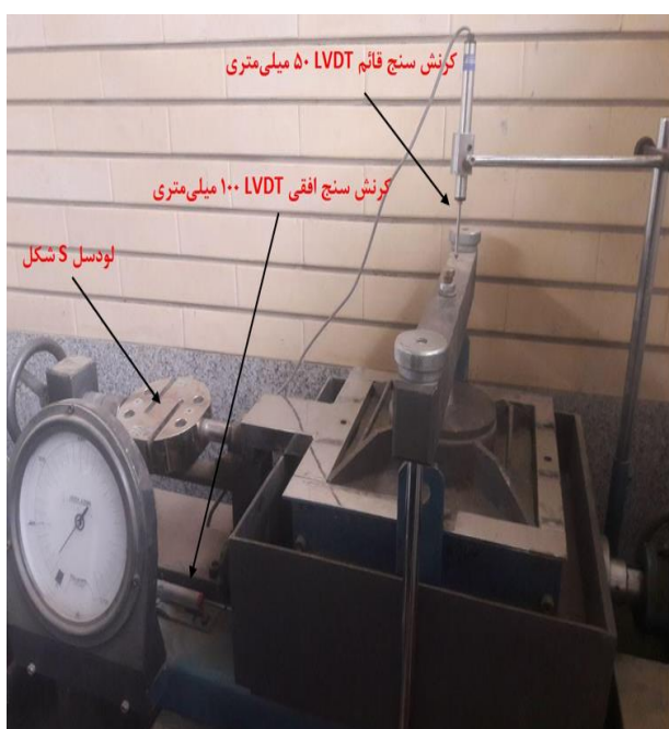
شکل ۳-۸ دیتالاگر و سنسورهای به‌کاررفته در این پژوهش
