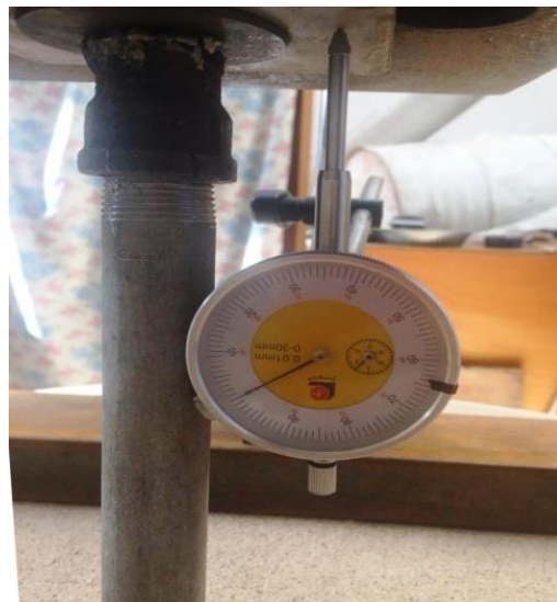
شکل ۳-۱۰ گیج نصب شده در زیر صفحه بارگذاری
