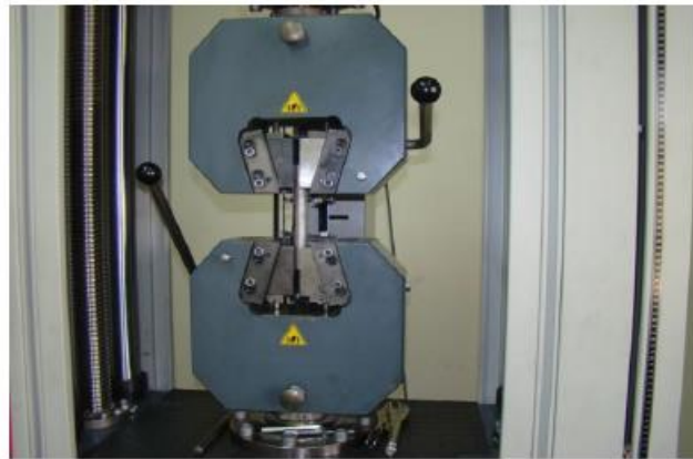
شکل ۳-۷ دستگاه کشش جهت تعیین مقاومت کششی نهایی شمعه‌های فولادی
