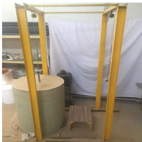
شکل ۳-۱۲ نحوه انتقال نیرو به شمع
