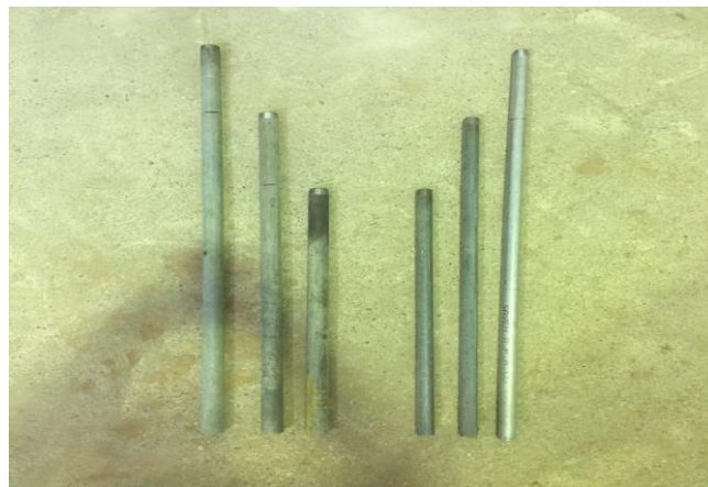
شکل ۳-۶ شمع‌های مورد استفاده در آزمایش
