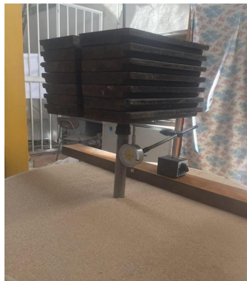
شکل ۳-۱۱ پایه مغناطیسی و گیج نصب شده بر روی آن
