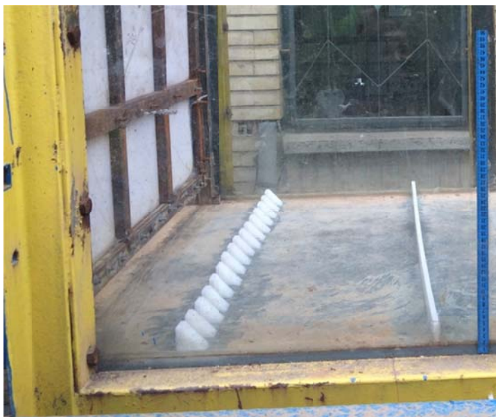
شکل ۳-۶: بلوک‌های میانی و آبپایه انتهایی بکار رفته در آزمایش
