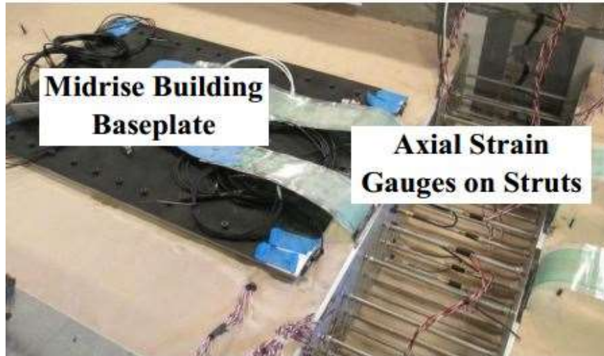
شکل ۳-۴ نمونه ای از مدل آزمایشگاهی سانتریفیوژ. (Jones, 2015)
